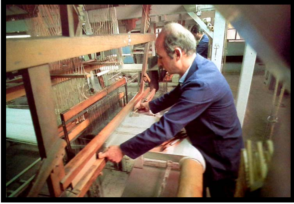
Şekil:3.4.5.23. Hereke Fabrikası, ipekli dokuma tezgahı
