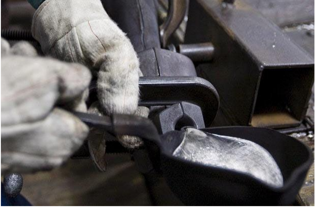
Şekil 3.4: Erimiş Metalin Kalıplara Dökülmesi Kaynak: (Oscar Heykelciği Nasıl Yapılıyor, 2009).
