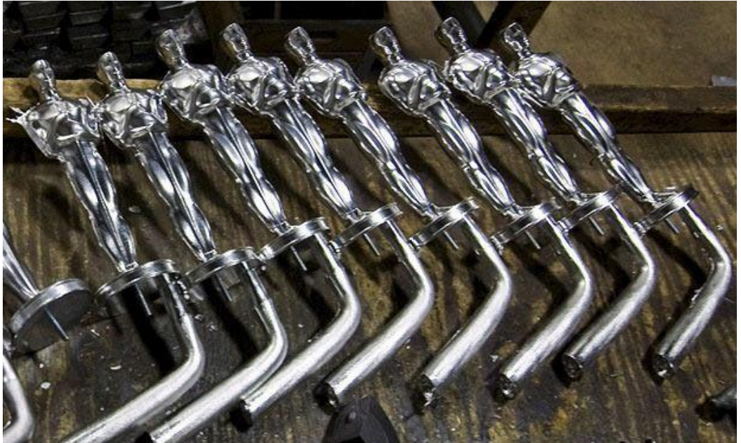
Şekil 3.7: Soğumaya bırakılan Oscar heykelleri Kaynak: (Oscar Heykelciği Nasıl Yapılıyor, 2009).
