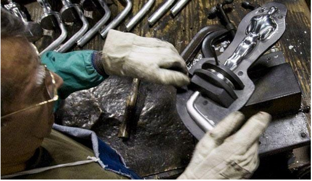
Şekil 3.6: Kalıpların çekiç yardımı ile açılması Kaynak: (Oscar Heykelciği Nasıl Yapılıyor, 2009).
