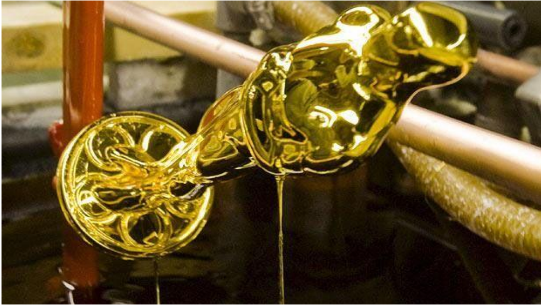
Şekil 3.13: Oscar Heykellerinin Altına Batırılması Kaynak: (Oscar Heykelciği Nasıl Yapılıyor, 2009).
