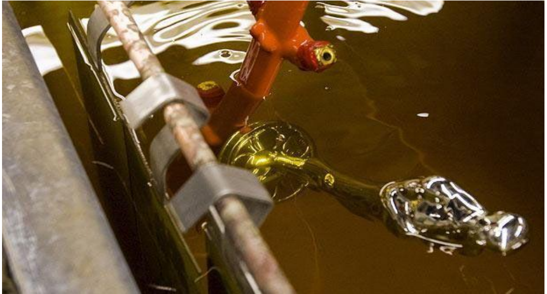
Şekil 3.11: Oscar Heykellerinin Nikelle Batırılması Kaynak: (Oscar Heykelciđi Nasıl Yapılıyor, 2009).
