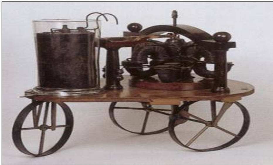
Şekil 2.2 Sibrandus Stratingh Tarafından Yapılan, İlk Elektrikli Karayolu Taşıtı Kaynak: www.rug.nl
