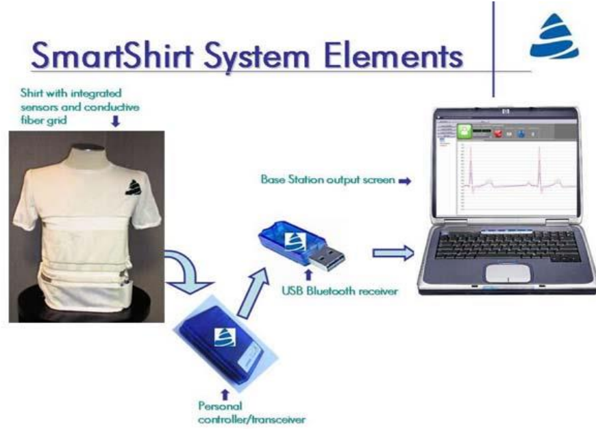
Şekil 10.1. : (Proetex 2010) SmartShirt Sistem Bağlantısı
