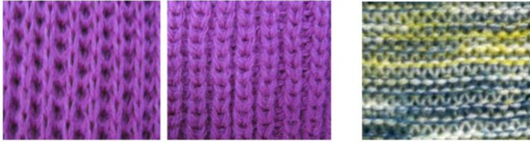
Şekil 6. 39 Yarım ve tam selanik örgülü kumaş ve haroşa düz örme kumaş
