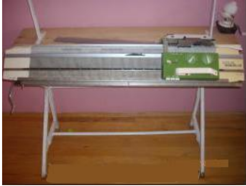
Şekil 6. 26 Ev Tipi Örne Makinesi
