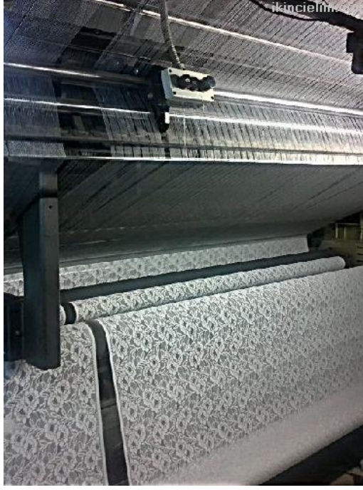
Şekil 6. 36 Jakarlı raşel örme makinesi
