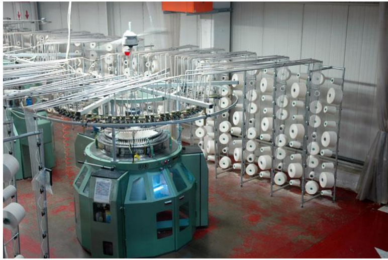
Şekil 6. 31 Tek yataklı dilli iğneli yuvarlak örme makinesi
