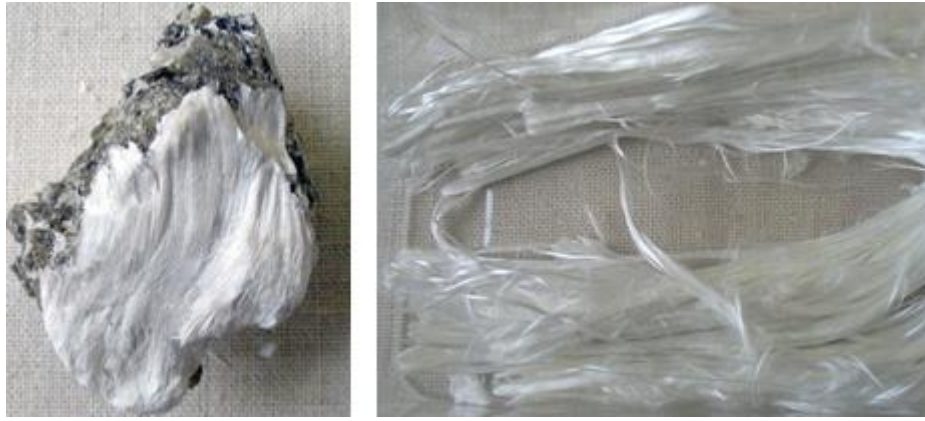
Şekil 2. 18 Sepantin kaya ve asbest elyafı
