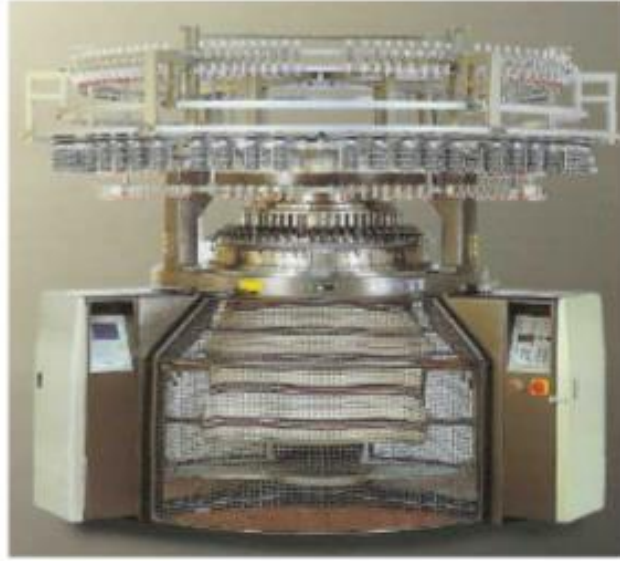
Şekil 6. 32 Çift yataklı dilli iğneli yuvarlak örme makinesi
