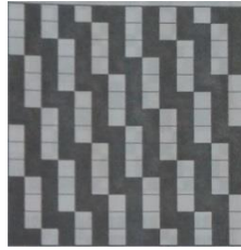
Şekil 3. 35 Hafif diyagonal ribs etkisi bırakan adria örgü bağlantı patronu
