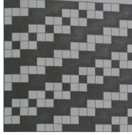
Şekil 3. 30 Dar Açılı Dimi Bağlantı Patronu
