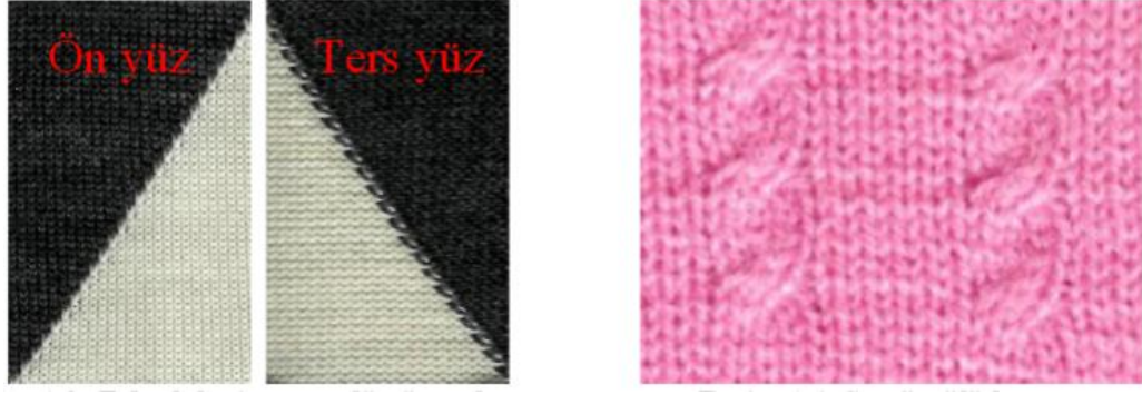
Şekil 6. 38 Tek plaka intarsia düz örme kumaş ve saç örgülü kumaş
