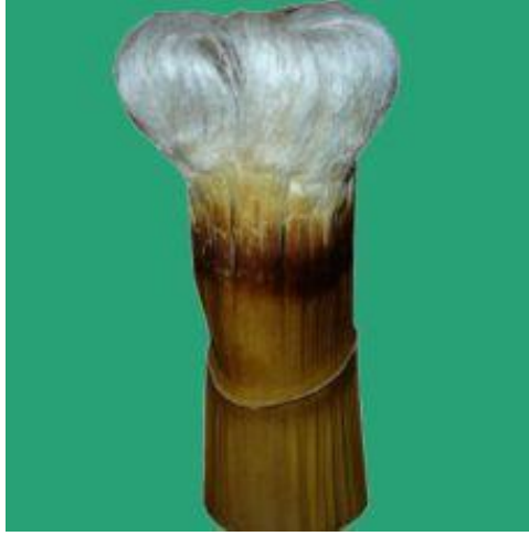
Şekil 2.9: Bambu Bitkisinin Yumuşatılıp Liflerden Ayrıştırılması Kaynak: http://okulsel.net/docs/index-121277.html?page=2 28.05.2014
