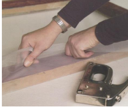
Şekil 3.20: Elek Bezinin Şablona Gerilmesi
