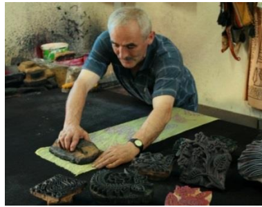
Şekil 3.15: Kalıpla Yapılan Yazmacılık
