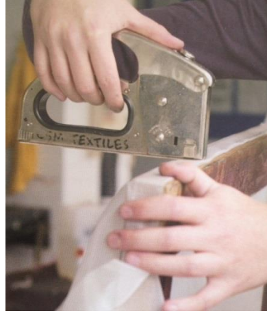
Şekil 3.21: Elek Bezinin Şablona Zımbalanması
