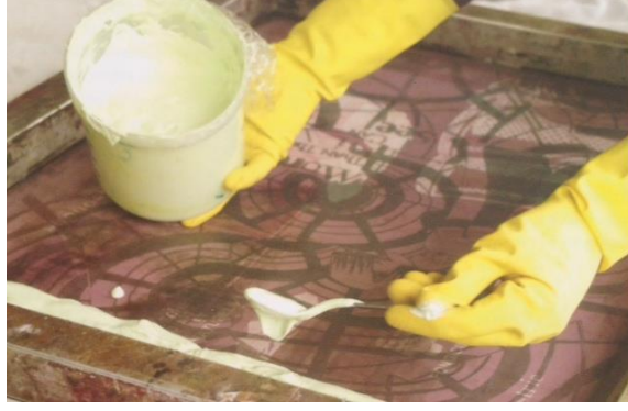
Şekil 3.26: Basılacak Boyanın Üst Kenara Konulması Kaynak: (Fish, 2012: 135).
