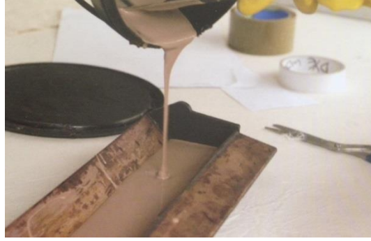
Şekil 3.23: Emülsiyonun Rakleye Dökülme İşlemi Kaynak: (Fish, 2012: 125).
