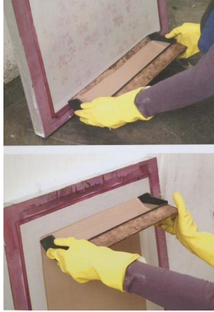
Şekil 3.23: Emülsiyonun Rakleye Dökülme İşlemi Kaynak: (Fish, 2012: 125).
