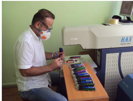
Şekil 3.39: Kalem Üzerine Lazer Baskı Yöntemi
