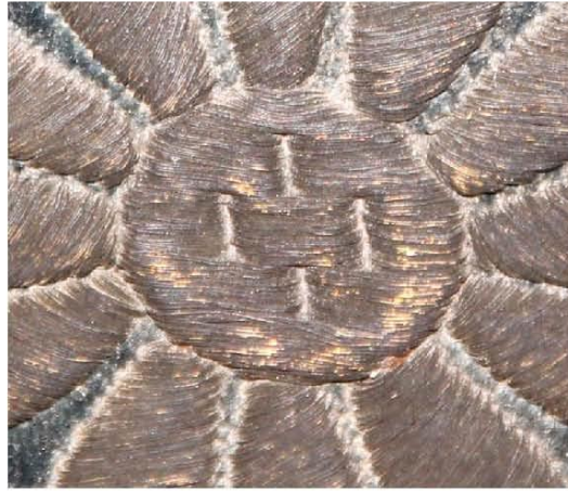
Resim 8. Yüzeydeki koyu renkli tabakanın sıyrıldığı kısımlarda görülebilen kıvılcı sarı renkli tel yüzeyi.
