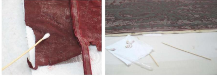
Resim 2. Kumaş lifleri, boyar maddeler ve kir birikimleri üzerinde yapılan testlerde kullanılan malzemeler (Mihrişah Valide Sultan Türbesi).
