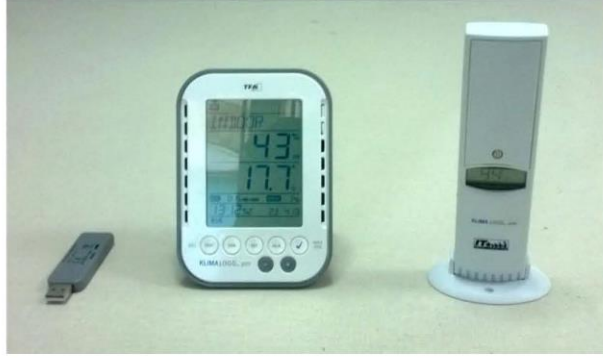
Resim 1. Bağıl nem ve sıcaklık verilerini kaydeden cihaz ve ona bağlı çalışan kablosuz sensör.
