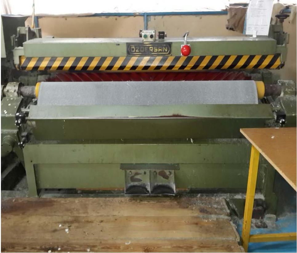
Şekil 6.6.2. Kuru Açk Makinası. Finisaj içinde bazen kullanılır. Kaynak: Semra ANAMUR
