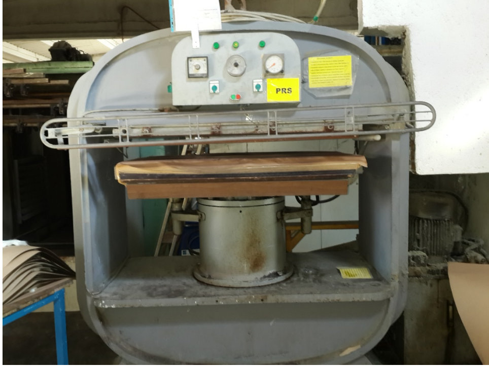
Şekil 6.7.7. Deri üzerine yapılan Baskılar için. (Baskı Makinesi) Kaynak: Semra ANAMUR
