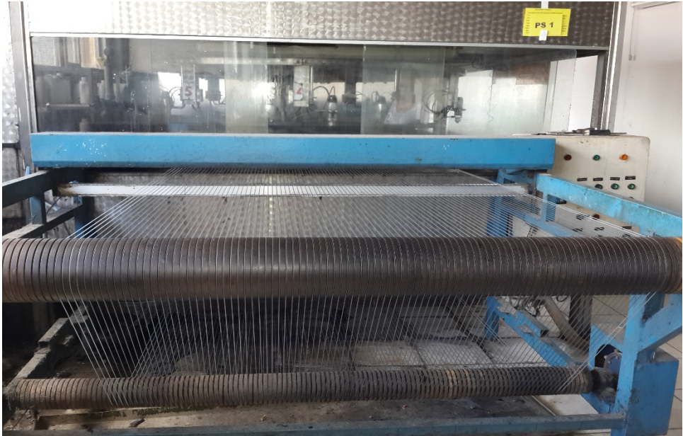
Şekil 6.7.2. Pistole Makinası . Deriler Bu Makinada, Üzerinde bulunan misina iplerin ilerlemesiyle makinanın içine girer ve burda boyanır. Kaynak: Semra ANAMUR
