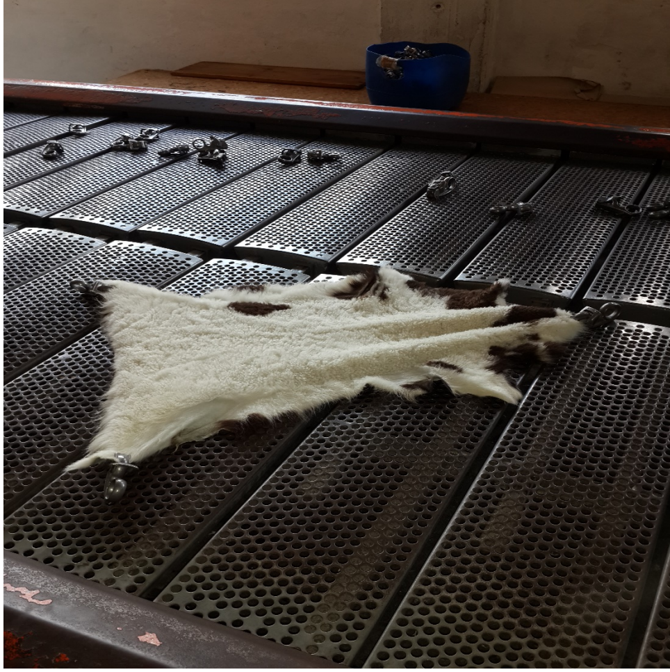
Őekil 6.10.1. Deriler ivilerle kenarlarından tutturularak gerdirilip bir sure bu Őekilde bekletilerek Hacim kazanması saėlanılır. Kaynak: Semra ANAMUR
