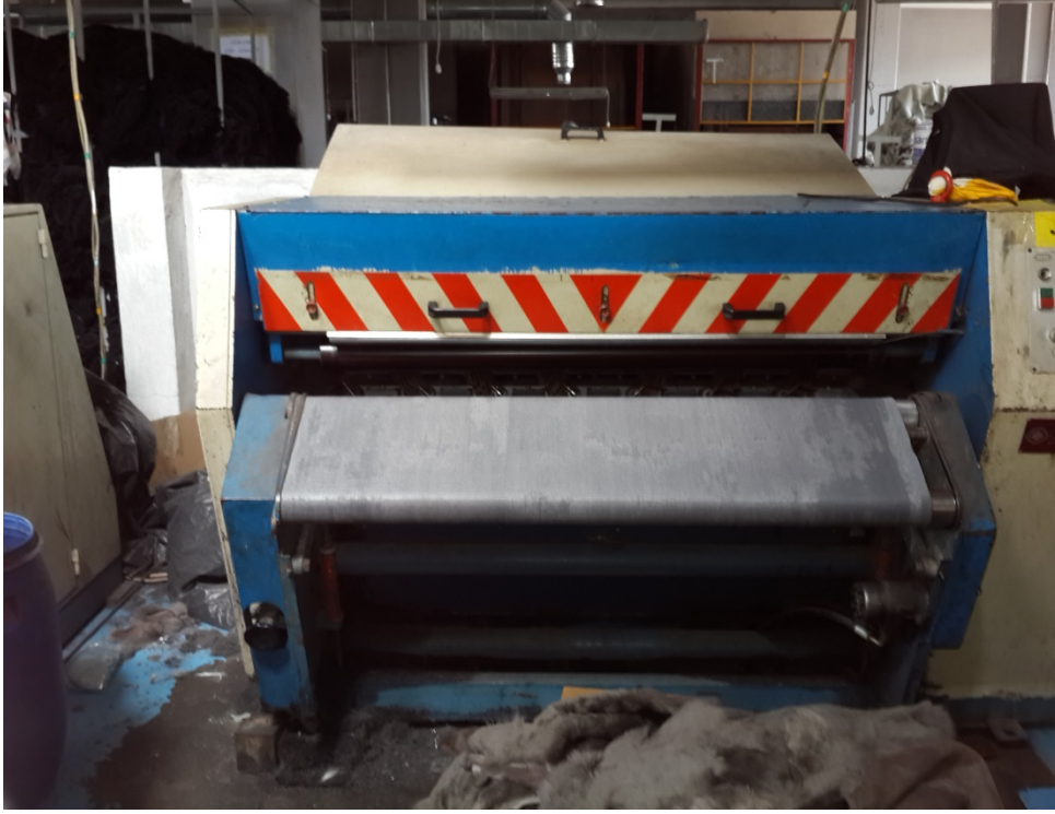
Şekil 6.6.3. Yatay Açkı Makinası. (Jumbo) Kaynak: Semra ANAMUR
