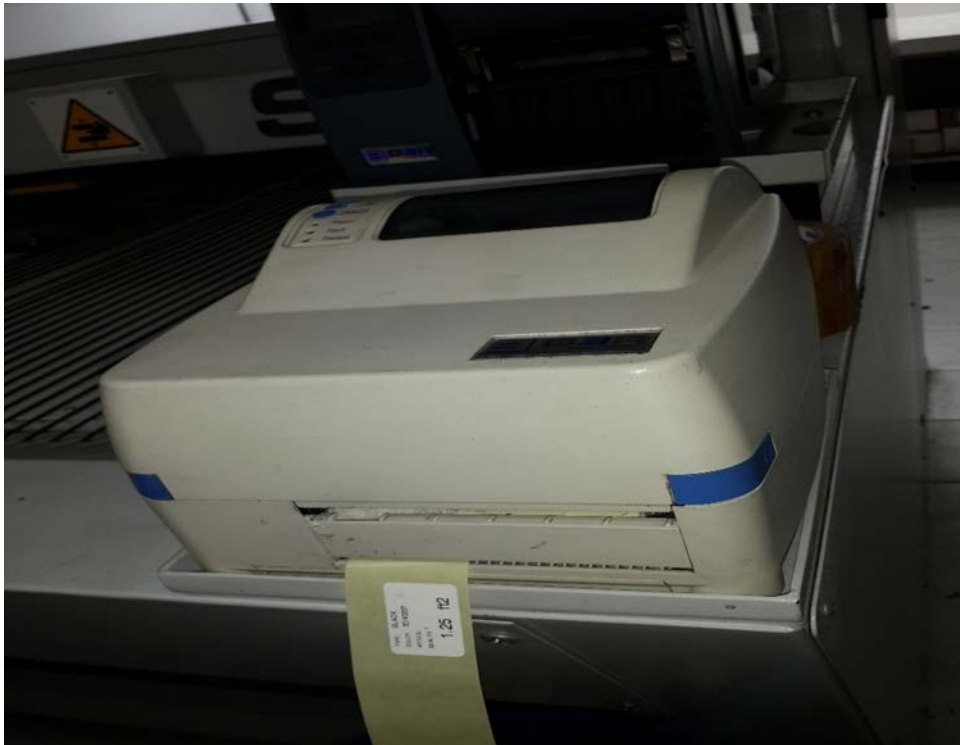
Şekil 6.9.2. Deriler Makinanın üzerindeki kayan bant üzerine verildikten sonra deri makinanın içinden geçip diğer tarafa geçirilerek ölçülür. Ölçüm sonucunda Makinanın otomatik etiket verme sisteminden çıkarılan etiketlerle etiketlenir. Kaynak: Semra ANAMUR
