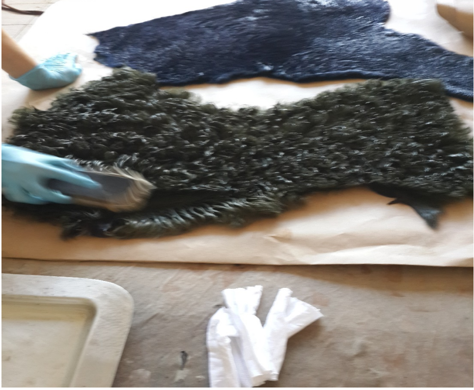
Şekil 6.11.1.3. Hazırlanan solüsyonun derinin kürklerinin ucuna bir fırça ile hafif sürülmesi. Kaynak: Semra ANAMUR
