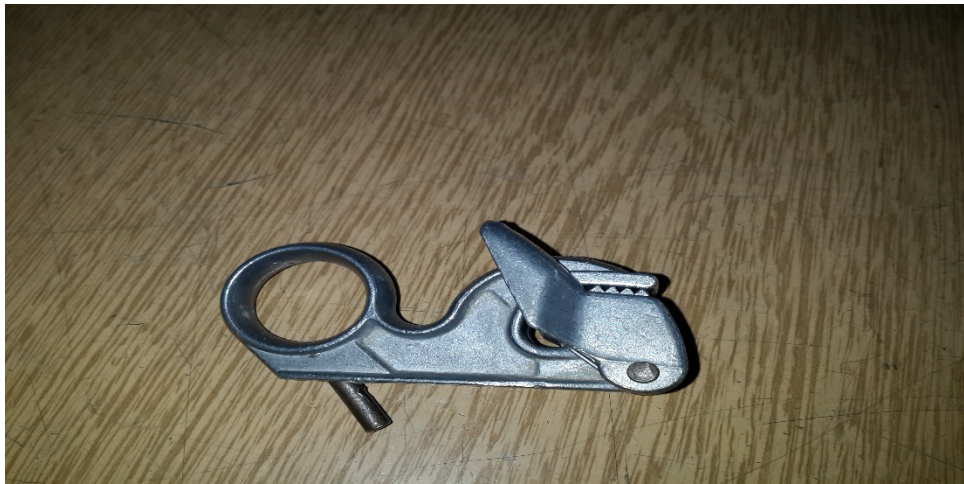
Őekil 6.10.2. Derilerin gerdirilmesi iin tutturulmasında kullanılan ivi. Kaynak: Semra ANAMUR
