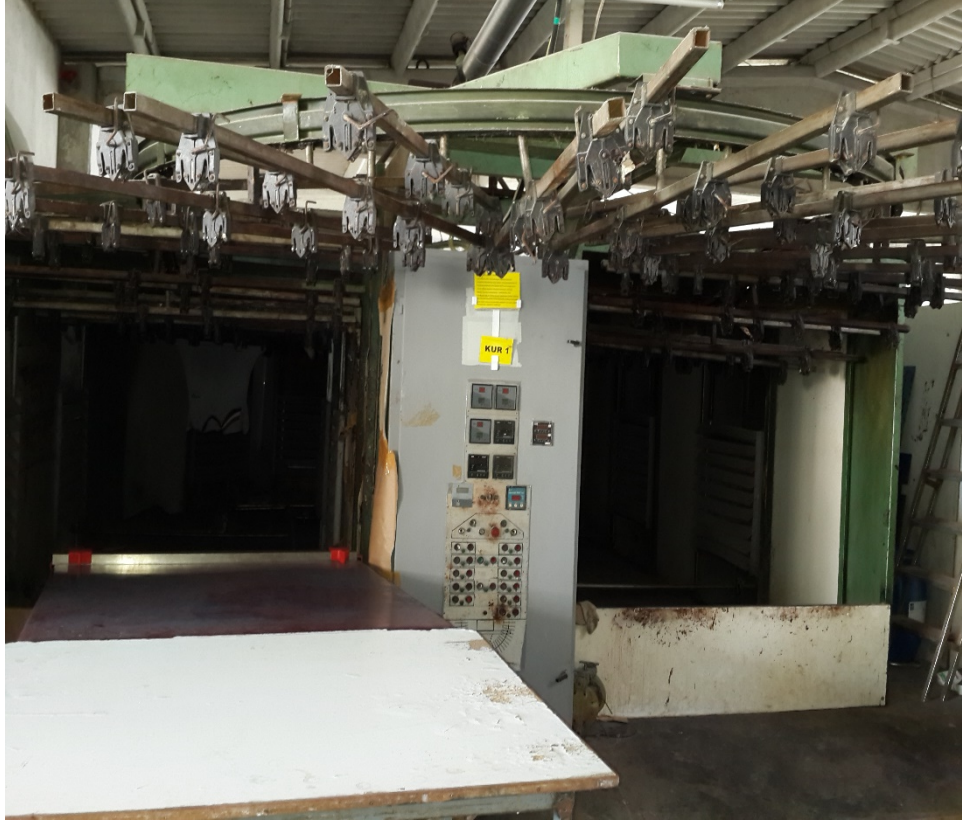
Şekil 6.12.2. Fanlı Kurutma Makinası. Hızlı Kurutma Sistemi. Kaynak:Semra ANAMUR
