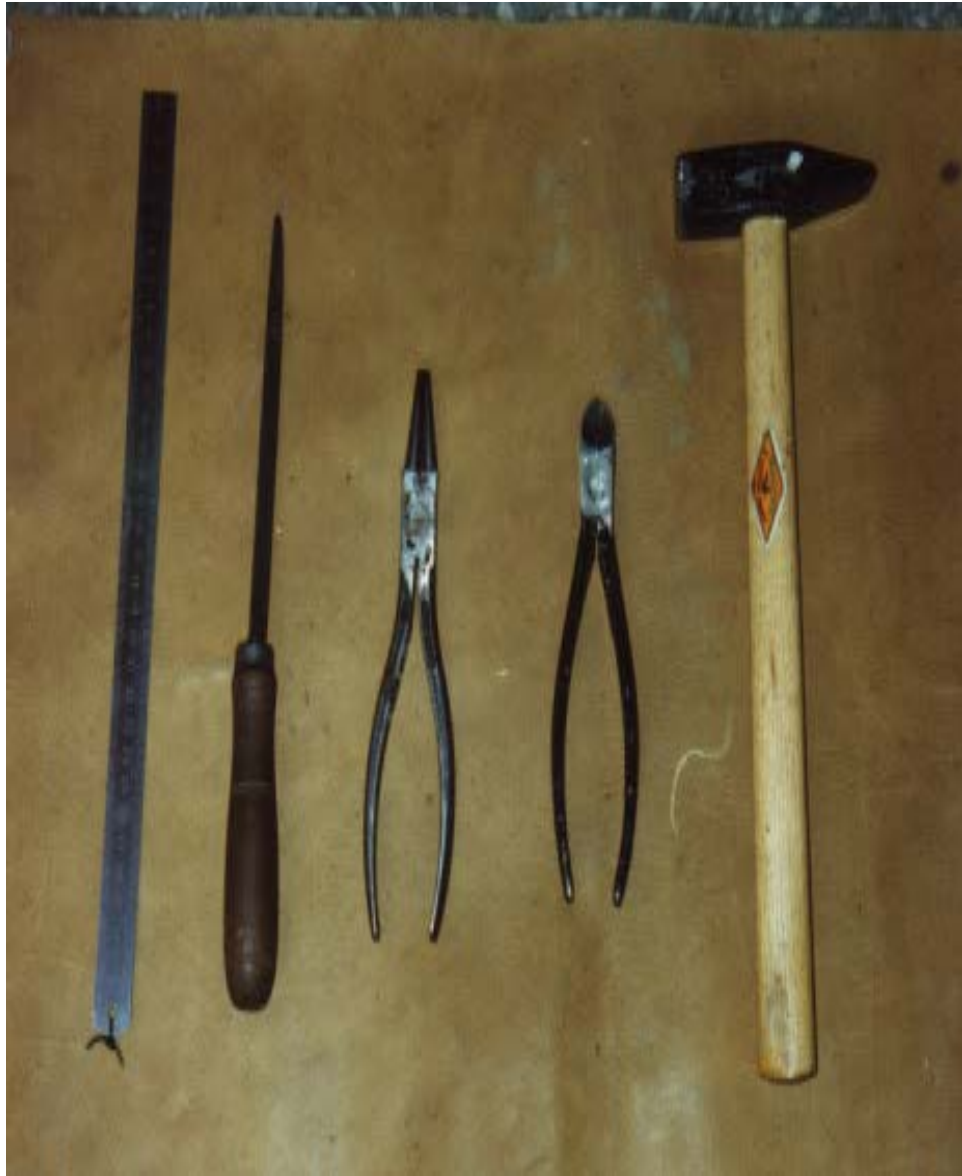
Şekil.7.1.4.3. Çelik cetvel, eğe, kargaburun, keski, çekiç
