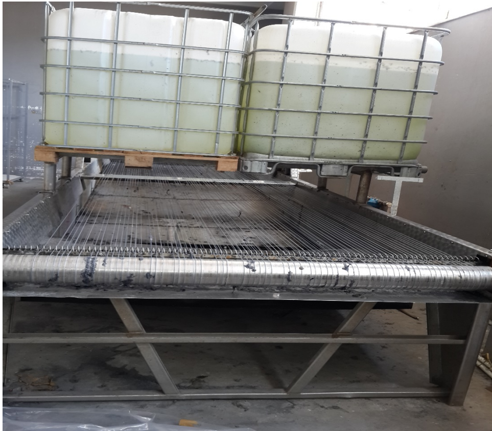
Şekil 6.6.6. Islatma Makinası. (Kürklü ve Suet Derileri Islatmak İçin Kullanılan Makine) Kaynak: Semra ANAMUR
