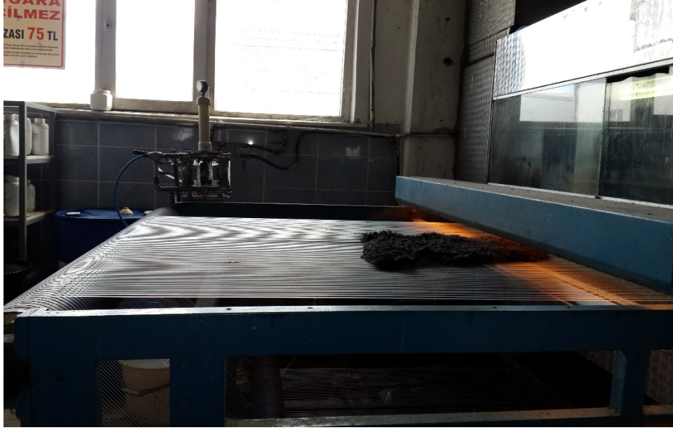
Şekil 6.7.3. Pistole Makinasında Derinin Boyanma Aşaması. Kaynak: Semra ANAMUR
