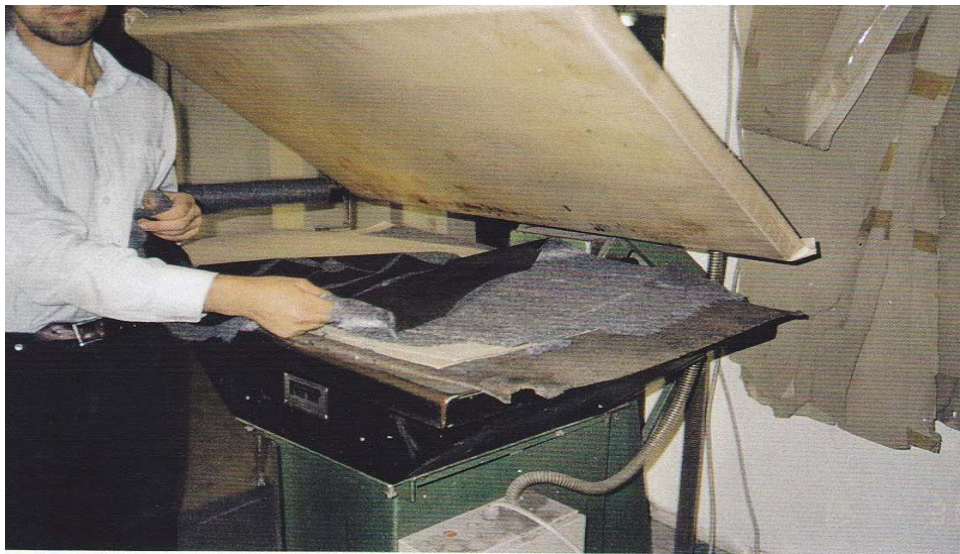
Şekil.10.1.8.4. Tela makinasında deriye telalama işlemi uygulanıyor.
