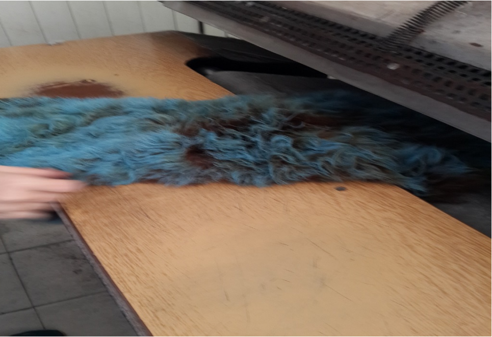
Şekil 6.11.1.6. Uçları açılan kürklü deriler ütü makinesinde ütülenmesi. Kaynak: Semra ANAMUR
