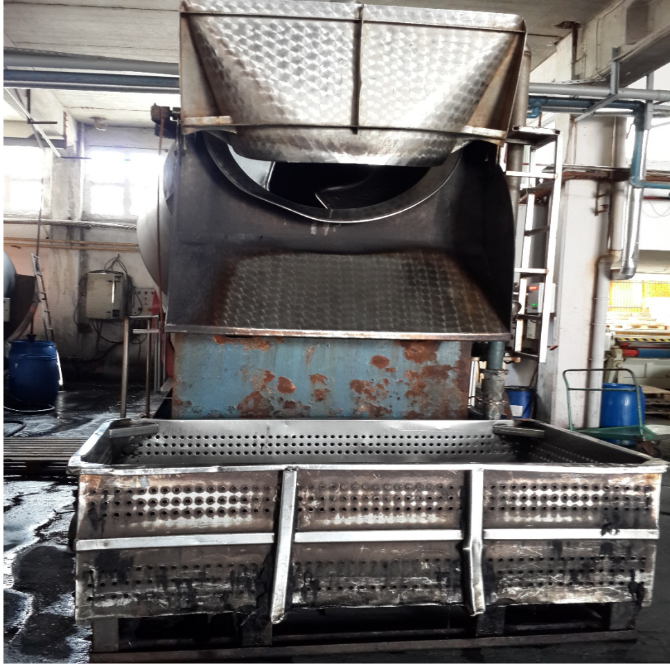
Şekil 6.4.2. Mikser ( Merdane) Makinasında boyama, yağlama, kromlama yapılır. Genelde tabaklama yağlama yapılır. Kaynak:Semra ANAMUR
