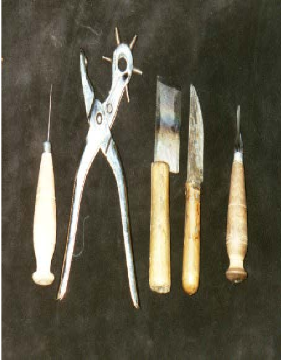
Şekil.7.1.2.1. Biz, çarklı zımba, bıçak, linol bıçağı
