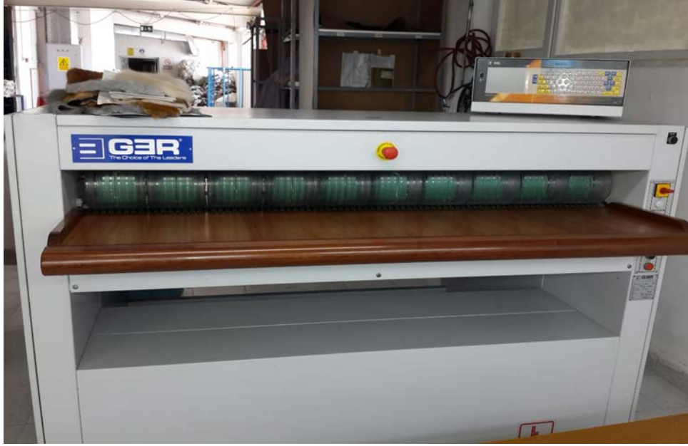
Şekil 6.9.1. Derilerin Ölçümünü yapmak için kullanılan Desi Makinası. Kaynak: Semra ANAMUR
