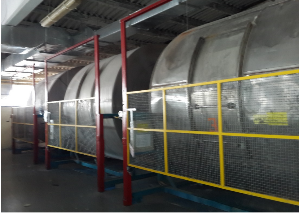
Şekil 6.6.1. Kuru Dolap. Derilerin Yumuşamasını Sağlar. Kaynak: Semra ANAMUR
