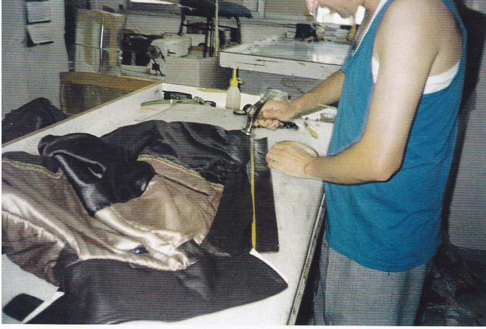
Şekil.10.1.8.3. Dikimhane bölümünde bir ayakçı ceket kenarına oya çekiyor.
