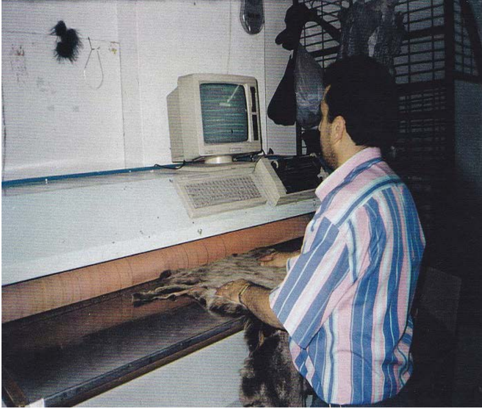
Şekil.10.1.1.1. Dersi makinasında derilerin ölçümlerinin yapılması Kaynak: Semra ANAMUR
