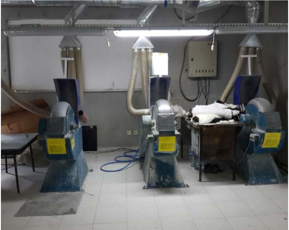
Şekil 6.5.2. Kuru Zımpara Makinası. Kaynak: Semra ANAMUR
