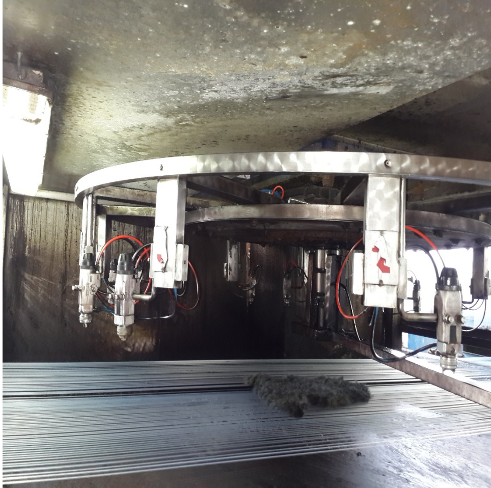
Şekil 6.7.4. Pistole Makinasında Derinin Boyanma Aşaması. Kaynak: Semra ANAMUR
