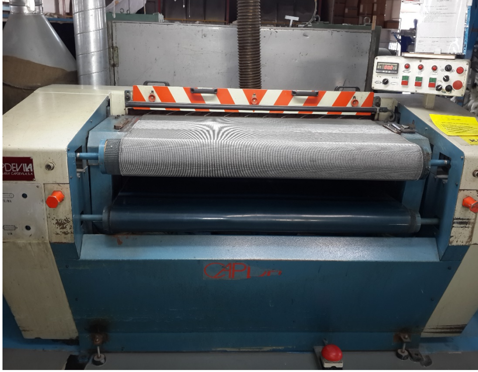
Şekil 6.6.5. Kürklü derilerde, Tüy Kırpma Makinası. (Tüy Boyunu Kısaltır.) Kaynak: Semra ANAMUR
