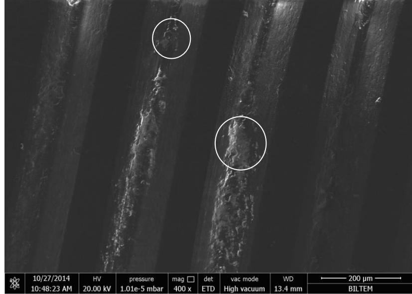
Şekil 4.10. D1-3_1 konumlu numaralandırılan görüntü olup D1 rumuzlu gramofon plağının merkeze yakın noktasında işaretlenmiş bölgeye karşılık gelen SEM görüntüsüdür.
