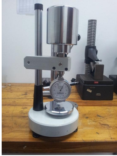
Şekil 4.32. Shore – Sertlik Ölçme Cihazı. Deniz Seltuğ tarafından fotoğrafı çekilmiştir.
