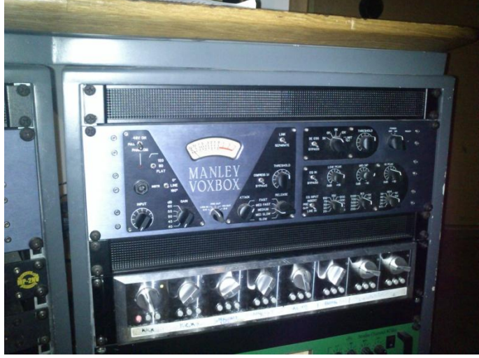
Şekil 5.1. Kullanılan Manley Voxbox Preamfi. Deniz Seltuğ tarafından fotoğrafı çekilmiştir.
