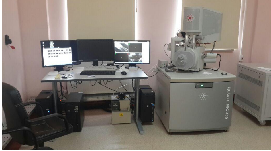
Şekil 4.2. Kullanılan SEM cihazı (Quanta Feg 450). Doç. Dr. İsmail Akdeniz tarafından fotoğrafı çekilmiştir.
