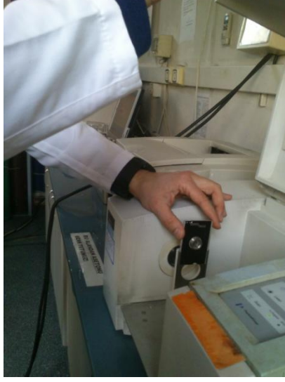
Şekil 4.16. Peletin cihaza yerleştirilmesi/ Numunenin havanda toz haline getirilmesi.
