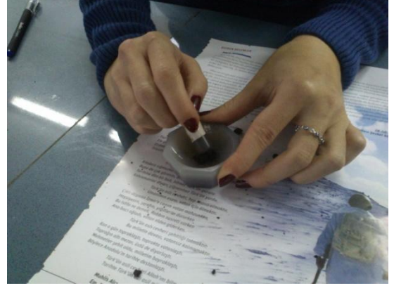
Şekil 4.16. Peletin cihaza yerleştirilmesi/ Numunenin havanda toz haline getirilmesi.
