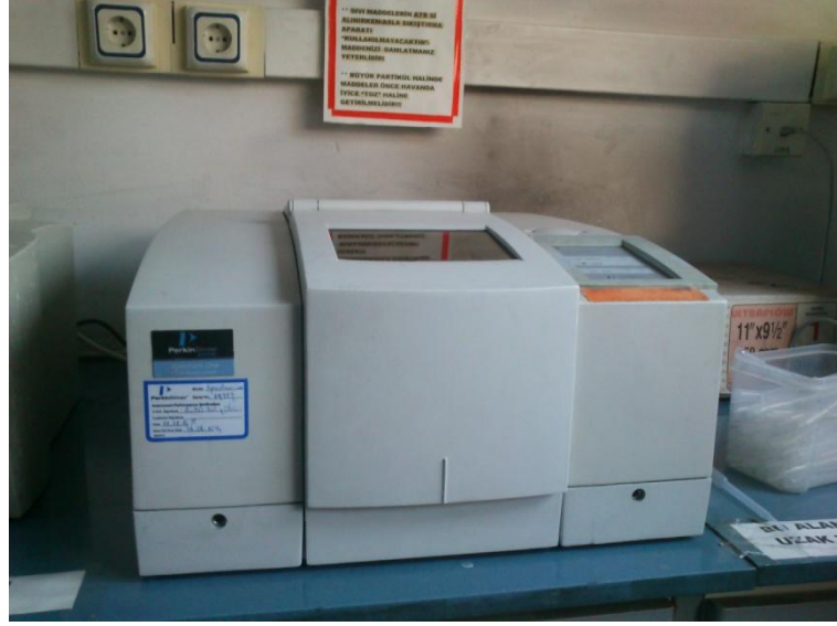
Şekil 4.15. ATR-FTIR Cihazı, Deniz Seltuğ tarafından fotoğrafı çekilmiştir.
