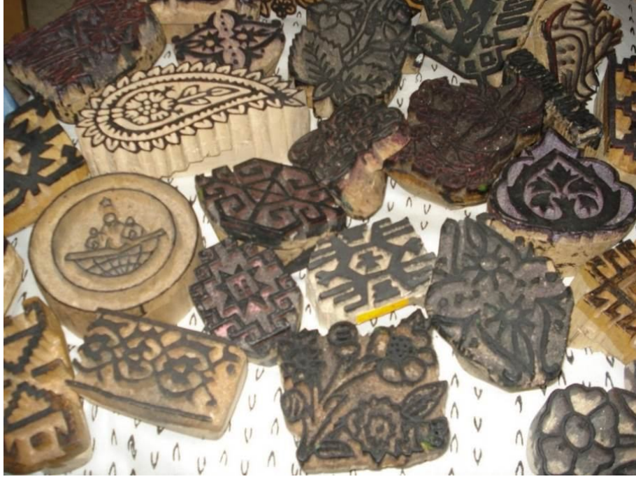
Şekil 2.133: Yazmacılıkta kullanılan elle oyulmuş ahşap kalıplar
