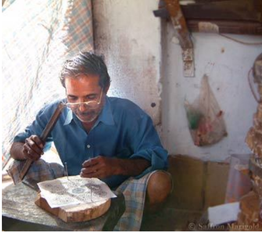
Şekil 2.166: Desen tasarımının aydınır kağıda çizilerek zımparalamış ağaca kopyalanması-Hindistan
