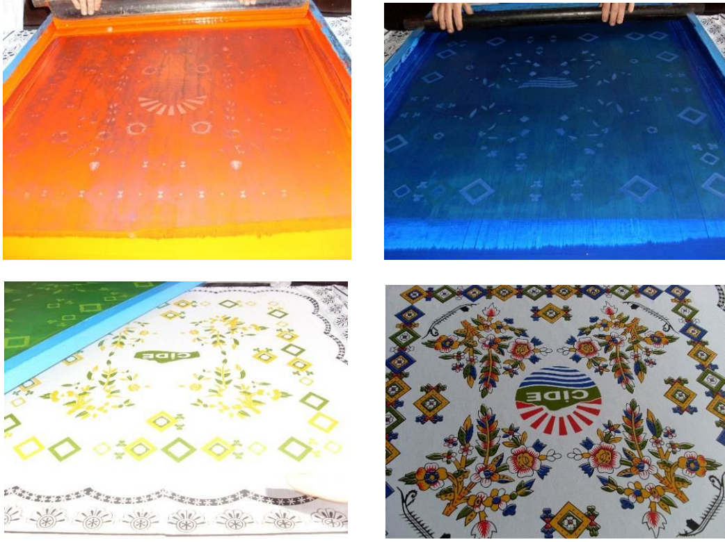
Şekil 2.130: Serigrafide her rengin ayrı basıldığı baskı süreci
