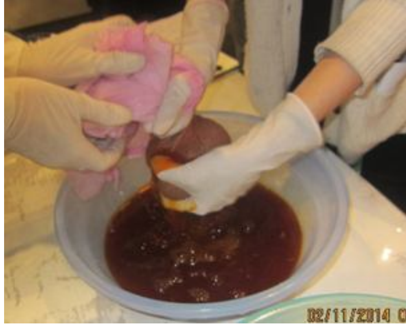
Şekil 3.61: Safflower'ın (yalancı safran-aspir) sitrik asit ilave edilen su dolu bir kap içinde bekletilerek ince bir kumaşla süzülme işlemi
