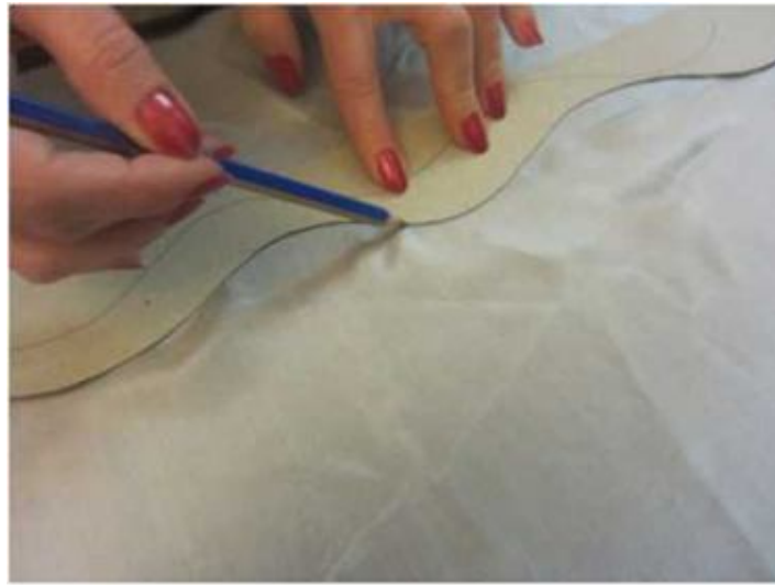
Şekil 3.84: İşlem 1. Ori-Nui Shibori uygulanacak kumaş parçası kalıp yardımıyla kumaşın kenarından başlayarak çizilir. İşlem 2. Boyanacak kumaşın tüm yüzeyi belirli aralıklarla işaretlenir.
