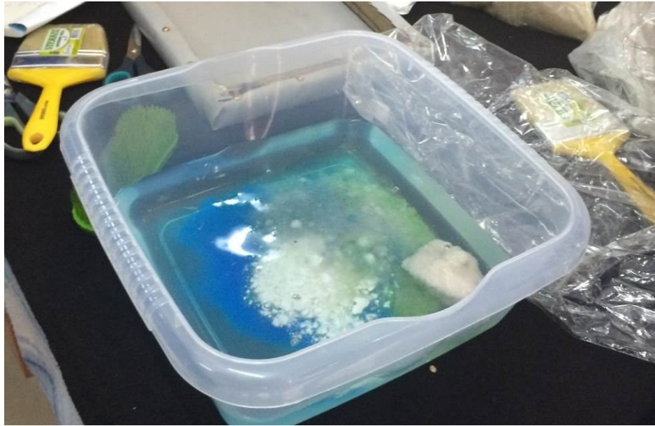
Şekil 2.148: Siyah analin boya yapımı için gerekli olan malzemeler: analin boya, göztaşı (bakır sülfat), potasyum kloratın (klorat potas) belirtilen ölçülerde su ile karıştırılması
