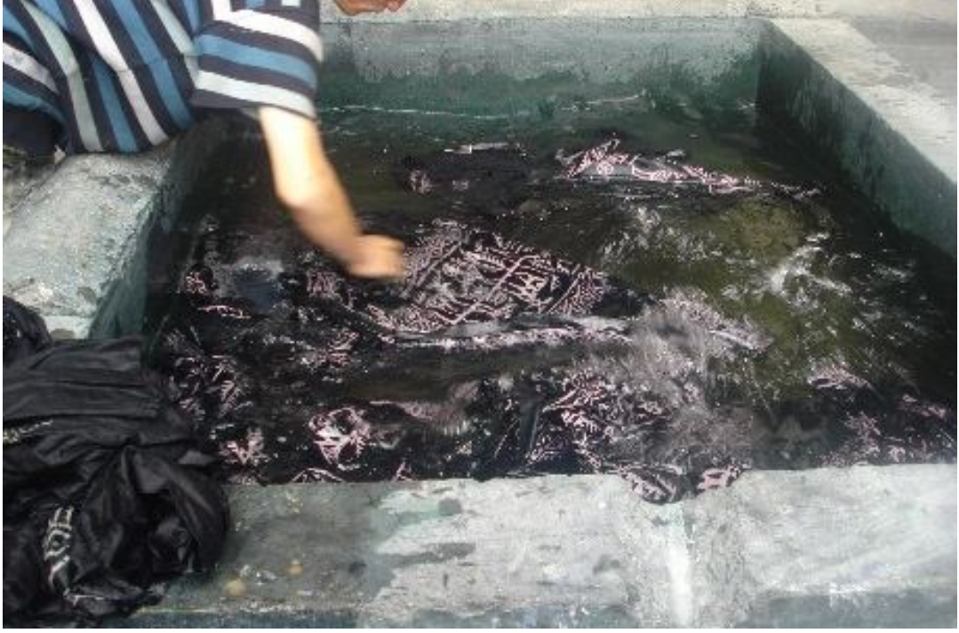
Şekil 2.160: Günümüzde Yüzüncü Yıl Yazmacılar Sitesinde yıkama havuzlarında amonyaklı suda durulanan yazmalar
