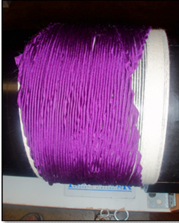
Şekil 3.117: Arashi Shibori uygulamasında kumaşın makine ile sarılması
