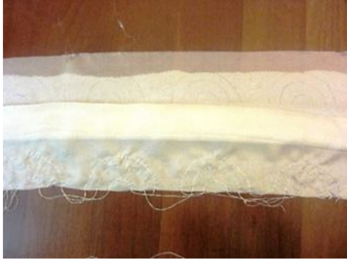
Şekil 3.88: İşlem1. Katlanan kumaş ortasına iç içe geçen yarım daireler çizilir. İşlem 2. Tüm çizilen yarım daireler el dikişi ile dikilir. ( Karamatsu Shibori -Dairesel dikişli )
