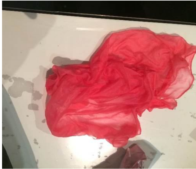
Şekil 3.63: Boyanmış kumaşların boya fikse işlemi için durulanması ve durulma sonu elde edilen renk
