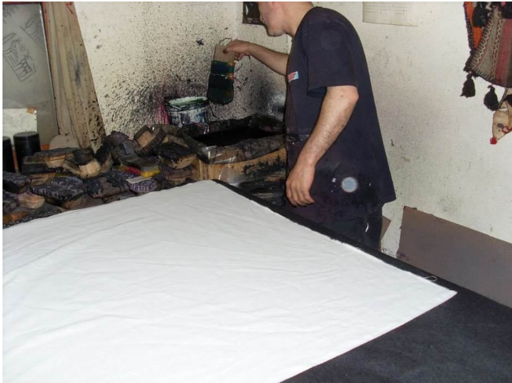
Şekil 2.146: Zamanla azalan boya teknesine boyanın “yağlanguç” ile ilave edilmesi
