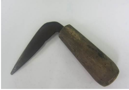
Şekil 2.135: Yazma kalıp oymacılığında kullanılan bıçak
