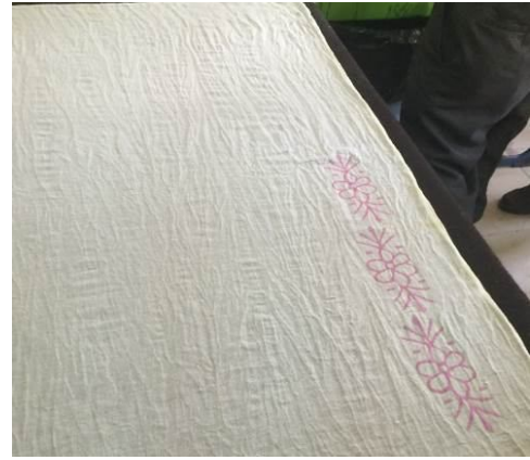
Şekil 2.150: Zemin boya içinde boyanın içinde kumaşların bastırılması ve nemli kumaş üzerine kireç boyanın basılması
