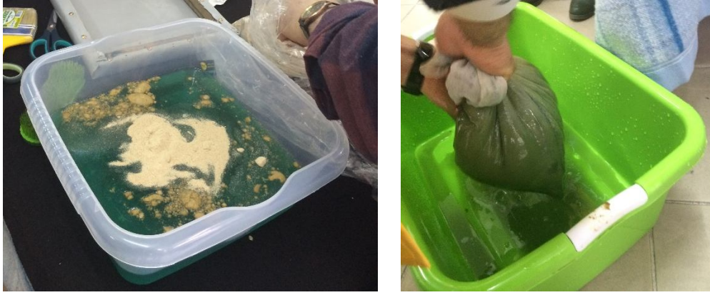
Şekil 2.149: Siyah analin boya eriğine kiriş katılarak karıştırılması ve kirişin içindeki tortulardan boyanın arındırılması için bez torba içinde süzülmesi
