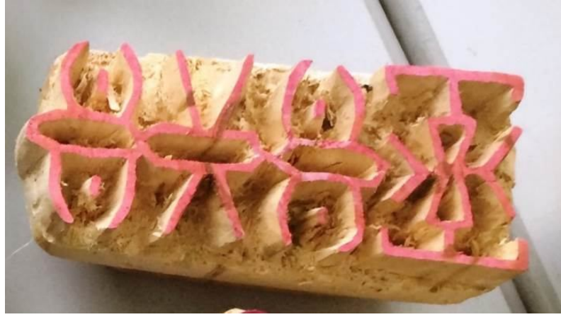
Şekil 2.114: Desenin kumaş boyunca sürekliliği düşüncesi ile “raportlu“ düzenlenmiş bir ahşap kalıp örneği
