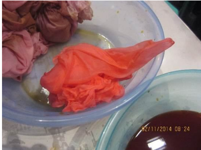
Şekil 3.62: Süzülen safflower'dan el edilen boyaya batılan kumaş ve bekletilerek boyanmış ipekli kumaş
