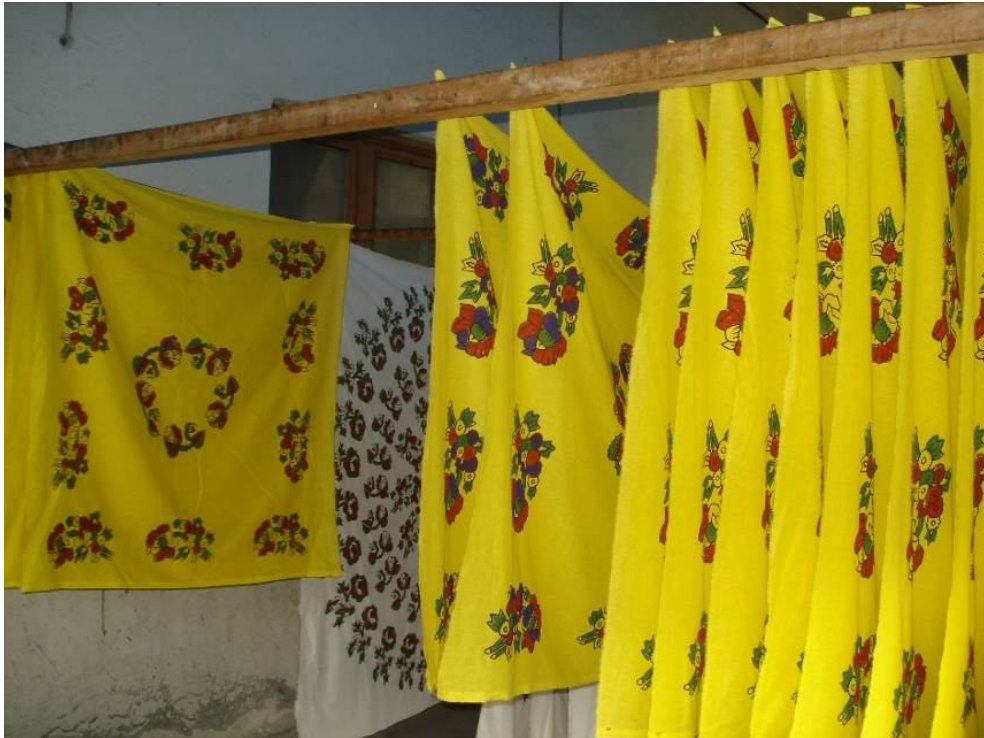
Şekil 2.152: Kapalı amonyaklı odalarda bekletilen yazmalar
