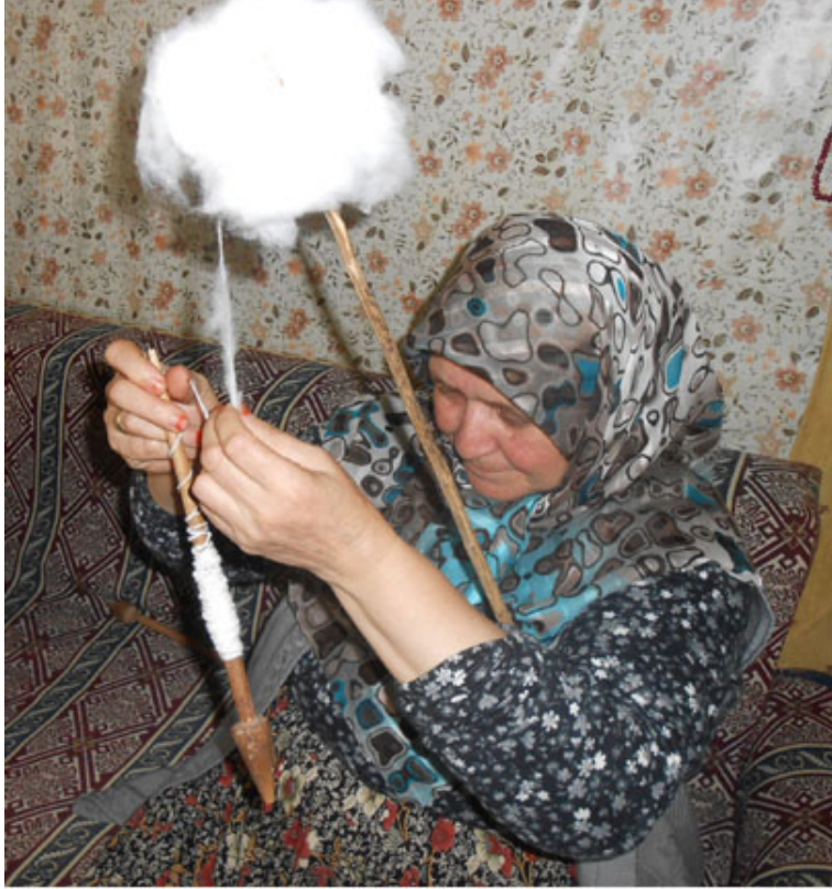
Fotoğraf 3.1.1. Pamuk ipliğinin iğ ile eğirilmesi
