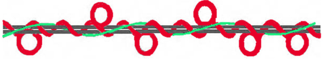
Şekil 4.3.4. Çift direkli efekt iplik şeması
