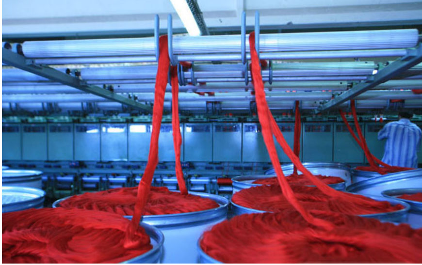
Fotoğraf 4.5.2. Fantezi iplik hazırlık-fitillerin kovalardan toplara aktarılması
