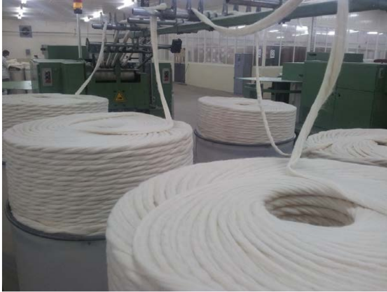
Fotoğraf 3.3.1.4. Hazırlanan vatıkların inceltilme aşaması
