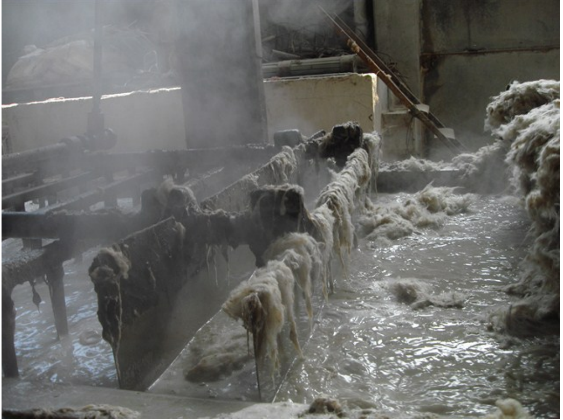
Fotoğraf 3.3.2.1. Yün elyafı yıkama işlemi
