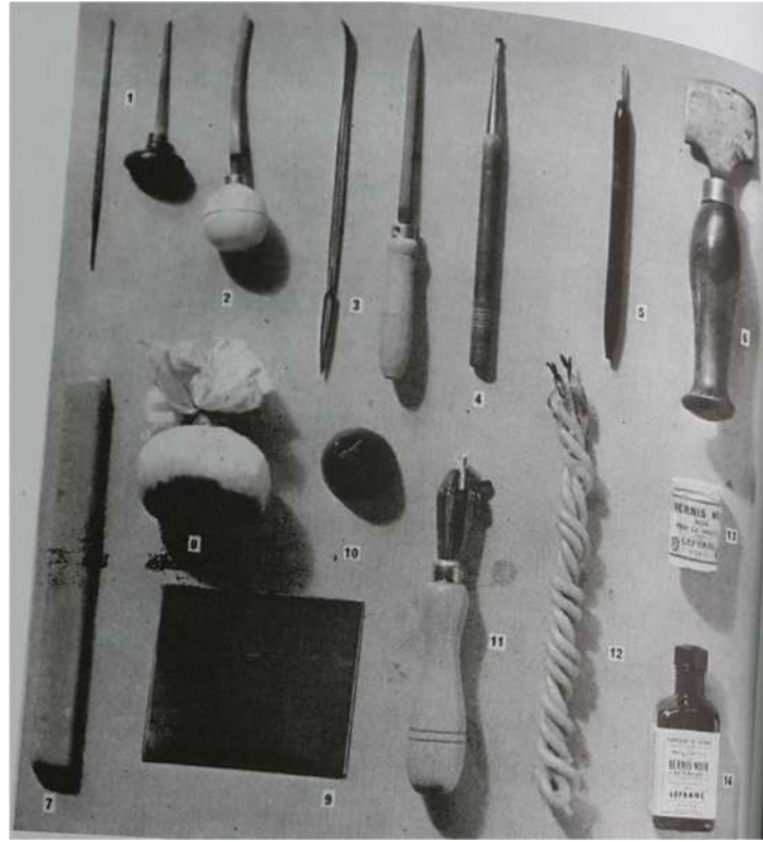
Şekil 3-62 1. Bürinler 2. Eğik Bürin 3. Kazıyıcı ve Parlatici 4. Rulet 5. Tığ/Kuru uç 6. Beşik/Berso 7. Balmumu 8. Tampon 9. Metal Plaka 10. Sert Vernik 11. Plaka Pensesi 12. Mum 13. Yumuşak Vernik 14. Asfalt Verniği
