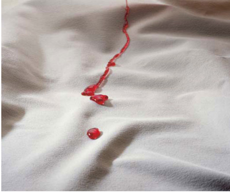
Şekil 4.26: NanoSphere kaplaması uygulanmış Schoeller'in "soft-shell" kumaşı
