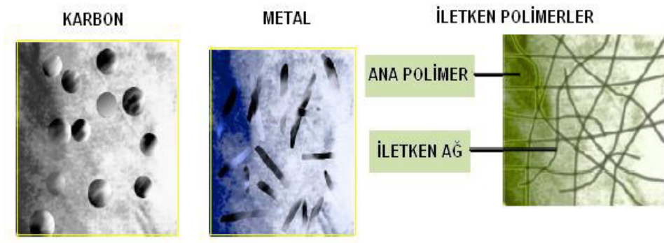
Şekil 4.1: Elektroiletken Bileşiklerin Tozuyla Doldurulmuş Polimerler 86
