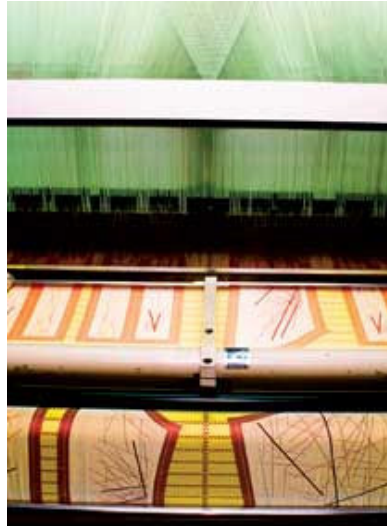
Şekil 5.26. A-POC ceketler, tezgahtan çıkmaktadır.
