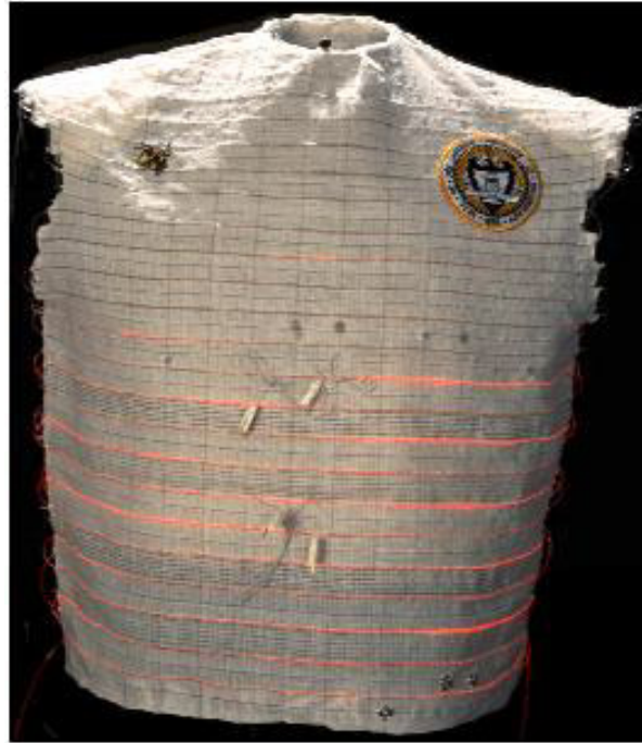
Şekil 4.4: Hayati Sinyalleri Tespit Eden Giysiler (Smart Shirt)
