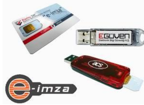
Şekil 2.4. e-İmza Uygulamalarında Kullanılan USB Dungle ile e-İmza Kartı Kaynak: www.firsatcenneti.com (çevrimiçi 10.12.2014)
