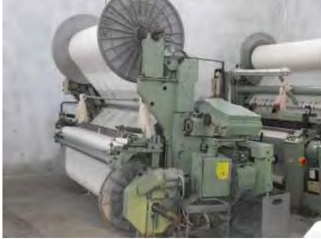
Şekil 6.3.4: Armürlü havlu dokuma makinesi (Yukarıdaki levenden gelen hav çözgüsü)
