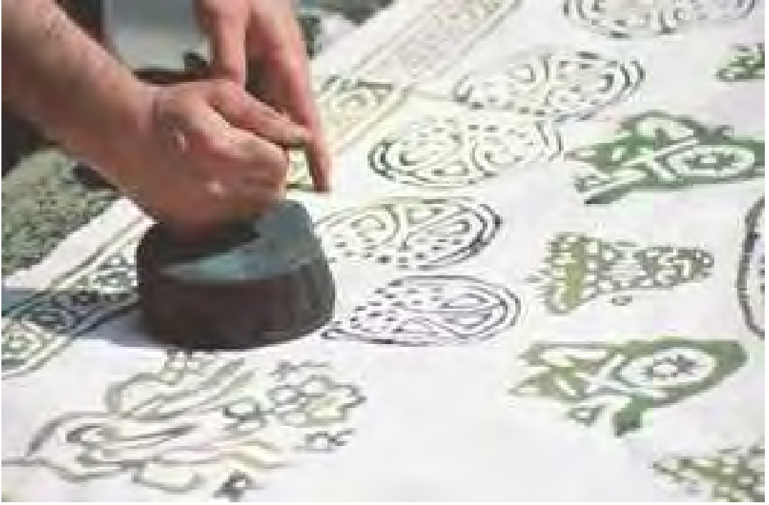
Şekil 3.48: Oyulmuş tahta kalıplarla baskı
