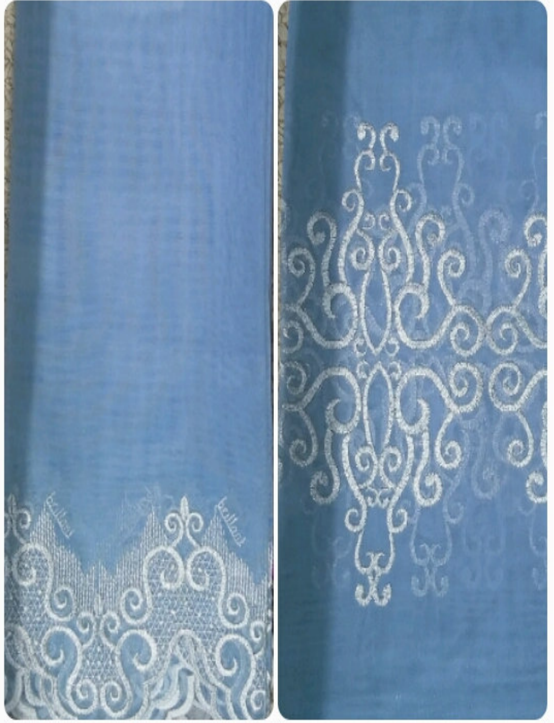
%100 Polyester (Peru) Zemine Önce Fotokromik Performans Kimyasalı İle Sıvıma Baskı Yapılan ve Sonra Üzerine %100 Polyester (504 Starlight Gümüş Simli) İplikle İşleme Yapılmış, Gün Işığına Maruz Bırakılan 1. Numune Örneği.
