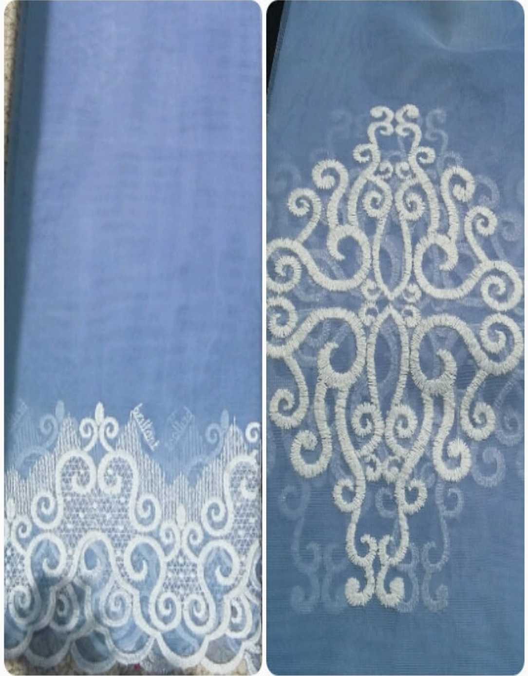
%100 Polyester (Peru) Zimine Önce Fotokromik Performans Kimyasalı İle Sıvıma Baskı Yapılan ve Sonra Üzerine %100 Polyester (504 Mat Sedef Simli) İplikle İşleme Yapılmış, Gün Işığına Maruz Bırakılan 1. Numune Örneği.
