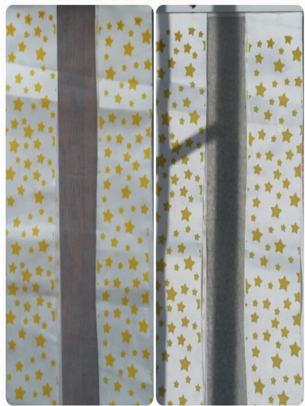
İşlemsiz %100 Polyester Zebra Zemin Üzerine, Fotokromik Performans Kimyasalı Kullanılarak Basılmış Olan, Turuncu Yıldız Desenli 2. Numune Örneği. Sağ Taraftaki Örnek Güneşe Maruz Bırakıldığında Sol Taraftaki Görünümü Almaktadır.
