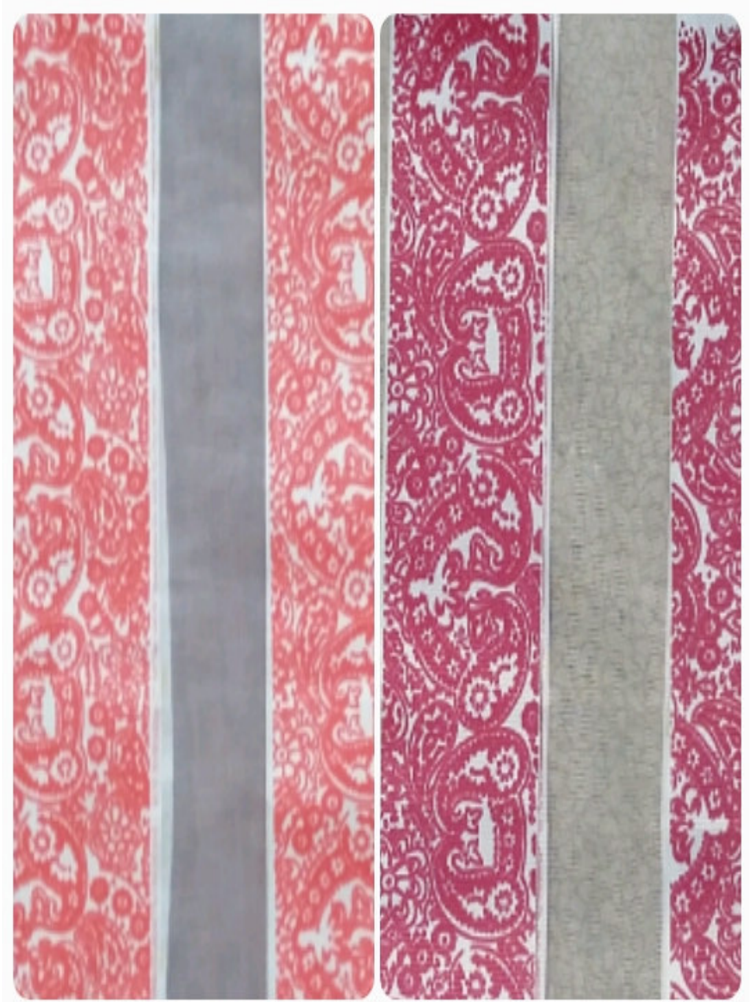
İşlemesiz %100 Polyester Zebra Zemin Üzerine, Fotokromik Performans Kimyasalı Kullanılarak Basılmış Olan, Kırmızı Şal Desenli 2. Numune Örneği. Sağ Taraftaki Örnek Güneşe Maruz Bırakıldığında Sol Taraftaki Görünümü Almaktadır.
