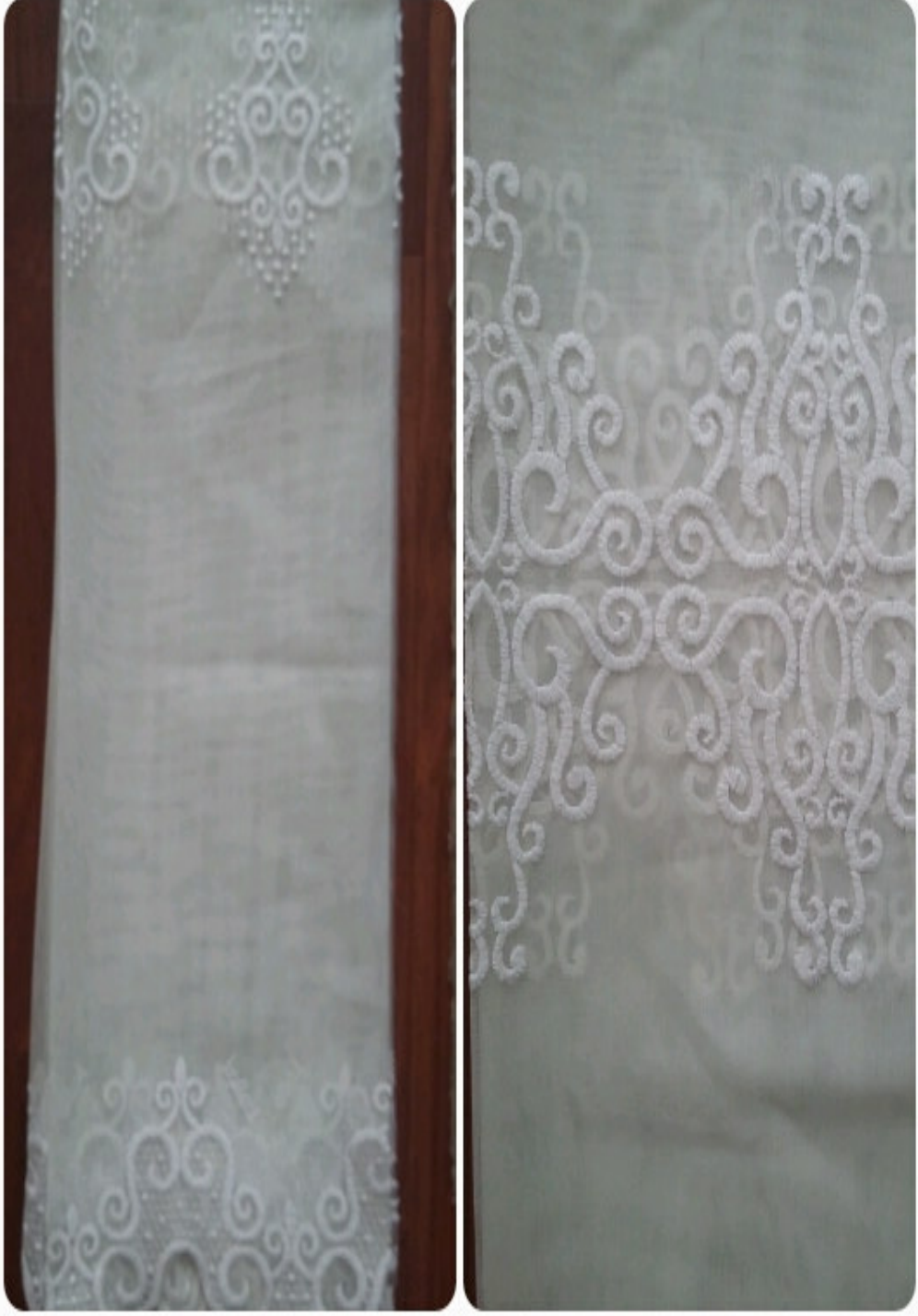
%100 Polyester (Peru) Zimine Önce Fotokromik Performans Kimyasalı İle Sıvıma Baskı Yapılan ve Sonra Üzerine %100 Polyester (504 Mat Sedef Simli) İplikle İşleme Yapılmış, Gün Işığına Maruz Bırakılmayan 1. Numune Örneği.
