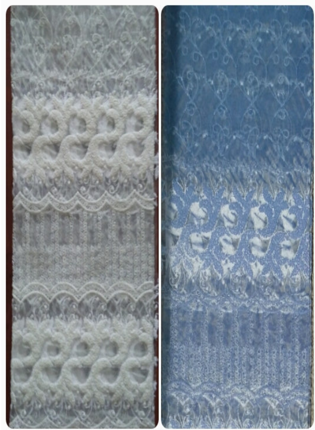
Örne platin zemin %100 polyester brode işlemeli Kumaş Üzerine Fotokromik Performans Kimyasalı Kullanılarak Basılmış Olan 3. Numune Örneği. Sağ Taraftaki Örnek Güneşe Maruz Bırakıldığında Sol Taraftaki Görünümü Almaktadır.
