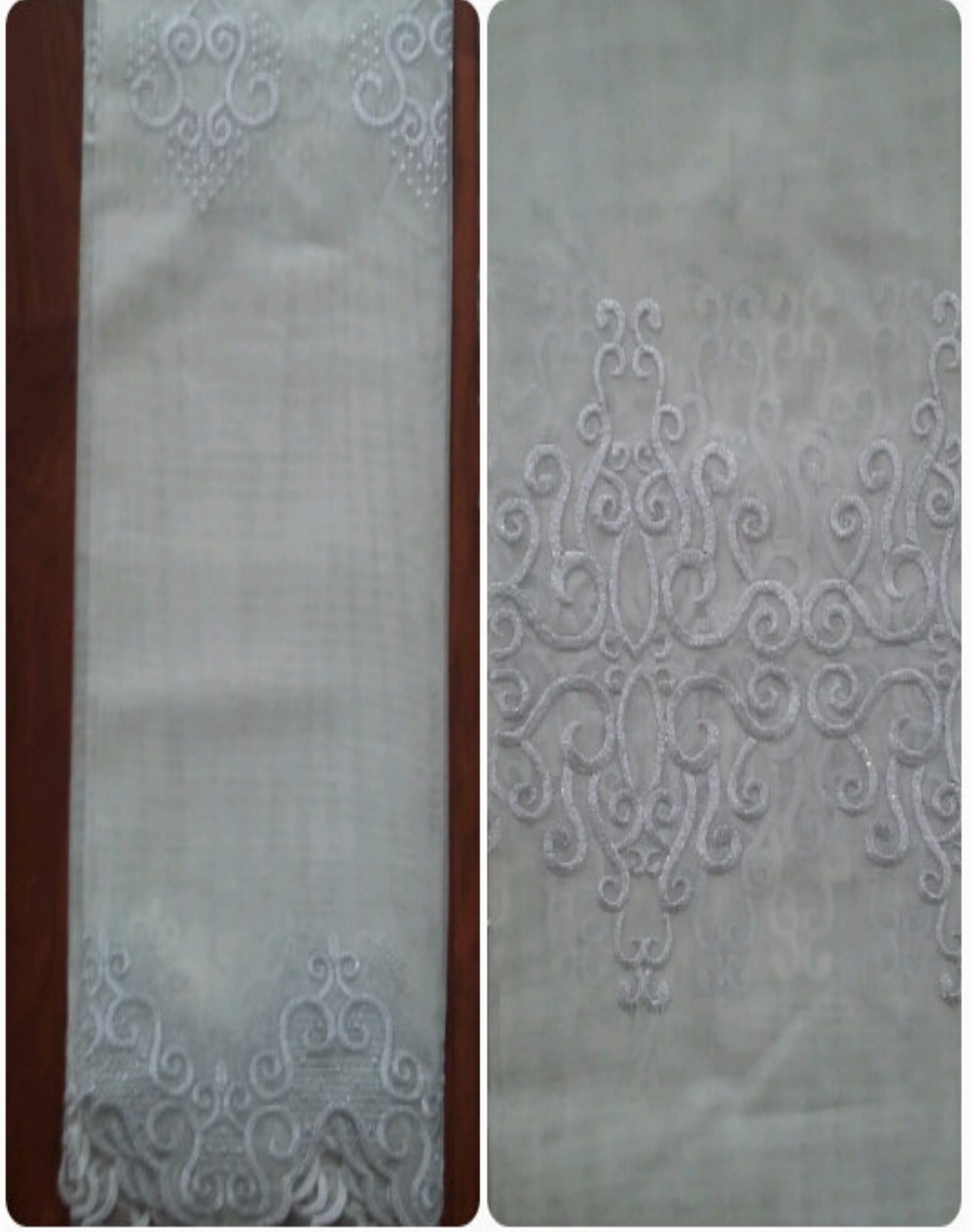
%100 Polyester (Peru) Zimine Önce Fotokromik Performans Kimyasalı İle Sıvıma Baskı Yapılan ve Sonra Üzerine %100 Polyester (504 Starlight Gümüş Simli) İplikle İşleme Yapılmış, Gün Işığına Maruz Bırakılmayan 1. Numune Örneği.
