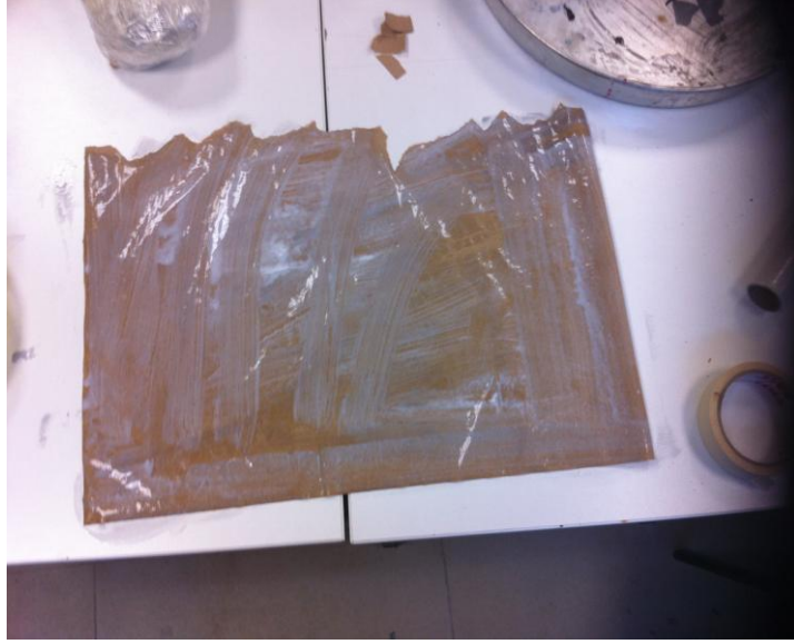
Şekil 8.156: Kraft kağıdının su, tutkal ve gliserinlenmesi (Çırpıcı,A., 2015, İst)
