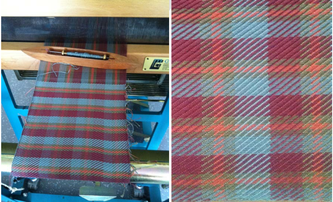
Şekil 2.1: Ekose desen dokunan tezgahta, çözü ve atkılarının görüntüsü(solda) ve ortaya çıkan ekose desen(sağda).
