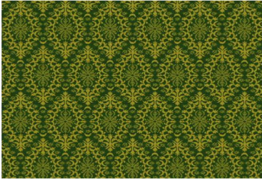
Şekil 7.1.3. Dokuma simülasyonu. 5'li çözgü sateni, 5'li atkı saten ve 1 dolu 4 boş dimi örgüleriyle örgülendirilmiştir.
