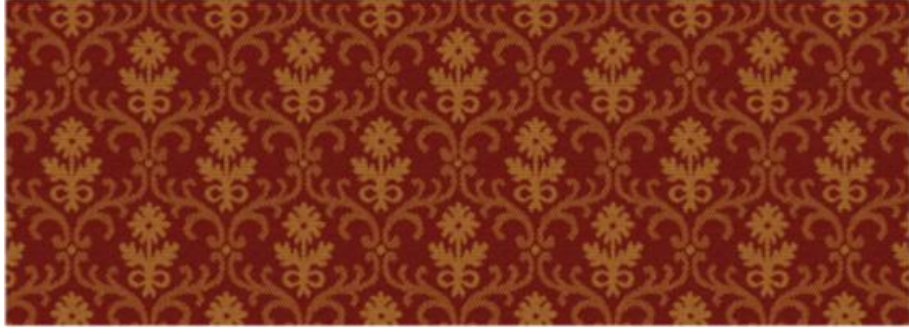
Şekil 7.1.2. Dokuma simülasyonu. 5'li çözgü sateni, 5'li atkı saten ve 1 dolu 4 boş dimi örgüleriyle örgülendirilmiştir.
