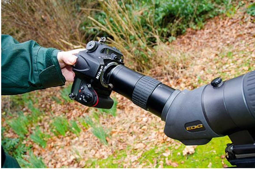
Şekil 3.16. Teleskopa monte edilen makine adaptörüne fotoğraf makinesi bağlantısı ( Kaynak: avasion1.com )
