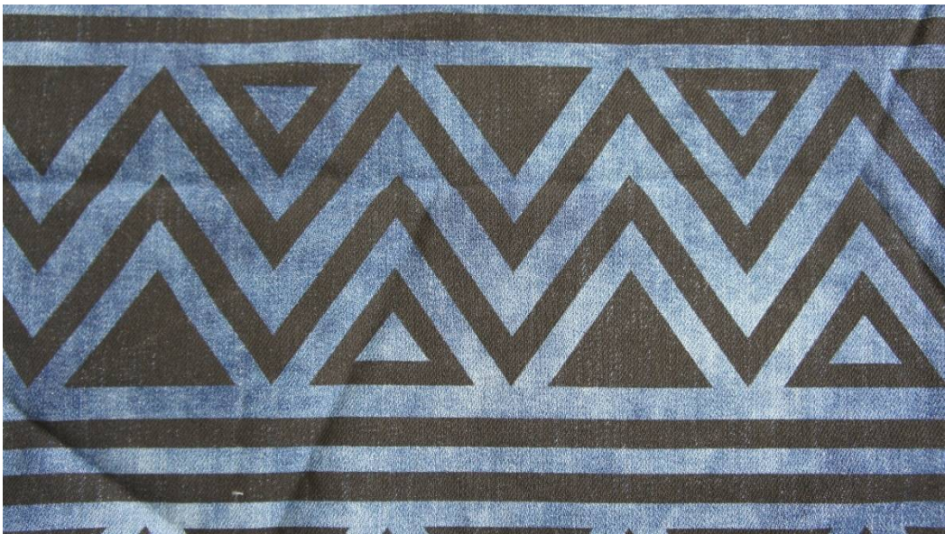
Şekil 6.18: Sodyum hipoklorit ile muamele edilmiş havlu bezler makinede susuz olarak denim kumaşla çarpıtılır. Kumaş üzerine rotasyon baskı yapılmıştır.
