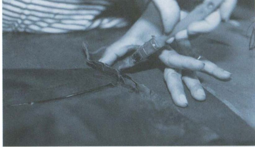
Şekil 4.11 Açık dikiş yapıştırma
