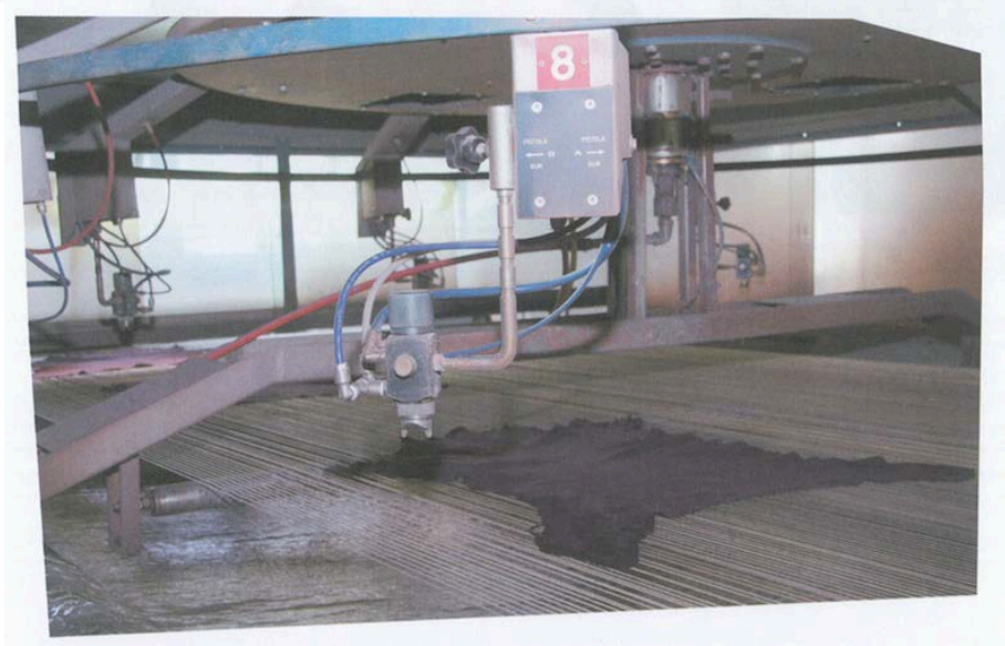
Şekil 4.4 Sprey boyama işlemi
