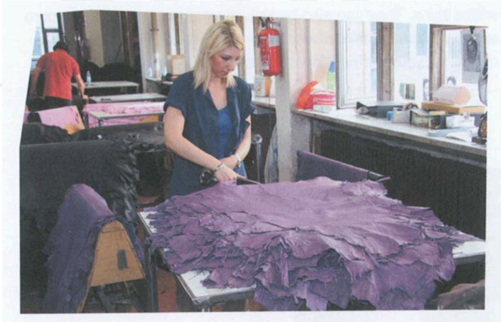
Şekil 4.2 Anilin işleminden sonra ayırma işlemi
