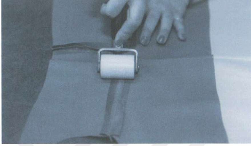
Őekil 4.12 Açık dikiř yapıřtırma son ařaması
