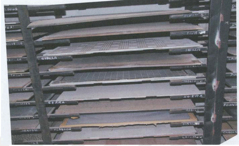
Şekil 4.5 Kabartma işleminde kullanılan kalıplar
