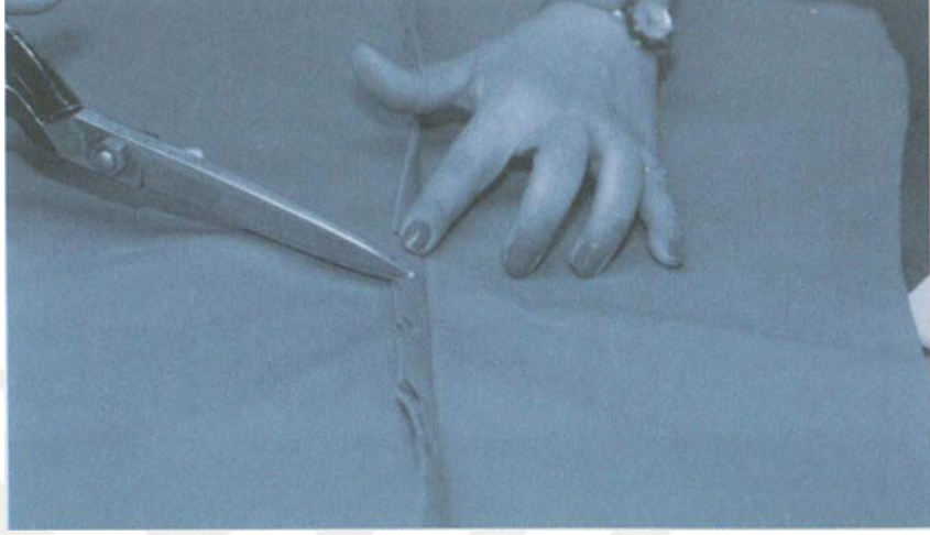
Şekil 4.10 Açık dikiş tekniği
