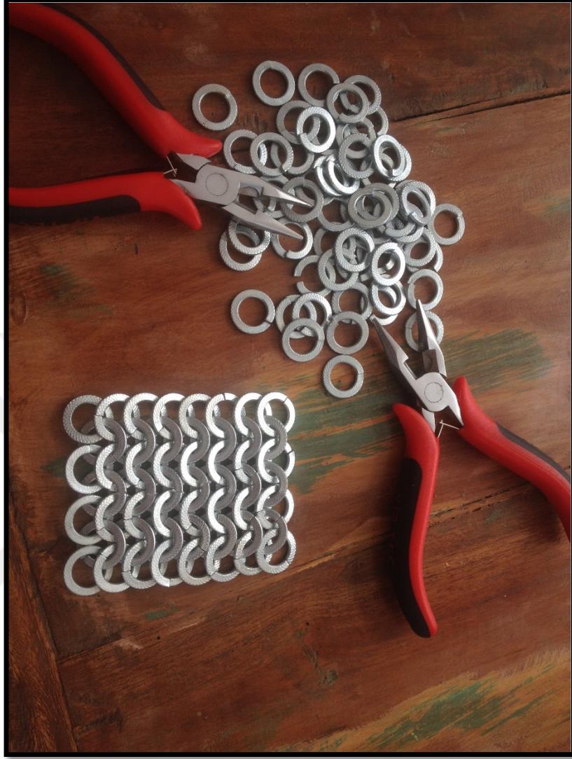
Şekil 6. 5: Demirden örme ense zırhı, el ile örülmüştür. Kaynak: Tunç Bilge, 2016, Maske Atölye Çalışması.
