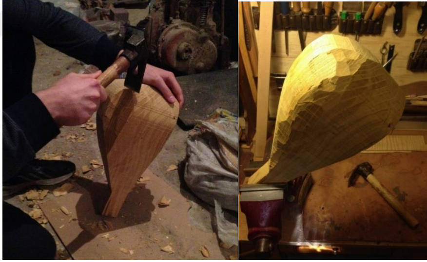
Şekil 3.3. 1 : Düz Keser İle Keserleme ve Pastran Koluna Hazırlanmış Hali.
