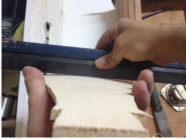
Şekil 3.6. 4 : Dış Bükey Verilmiş Ses Tablası
