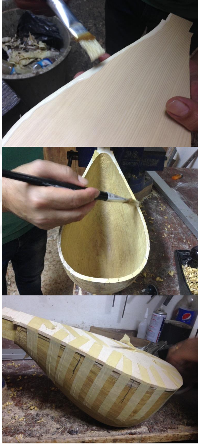
Şekil 3.6. 5 : Ses Kutusu Tutkallama ve Sıkıştırma İşlemi
