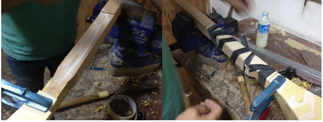
Şekil 3.7. 1 : Geçiçi Klavyenin Montajı
