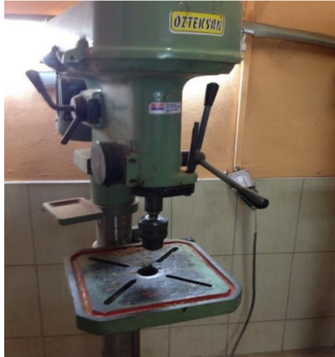
Şekil 2.1. 4 : Dikey Delik Makinesi
