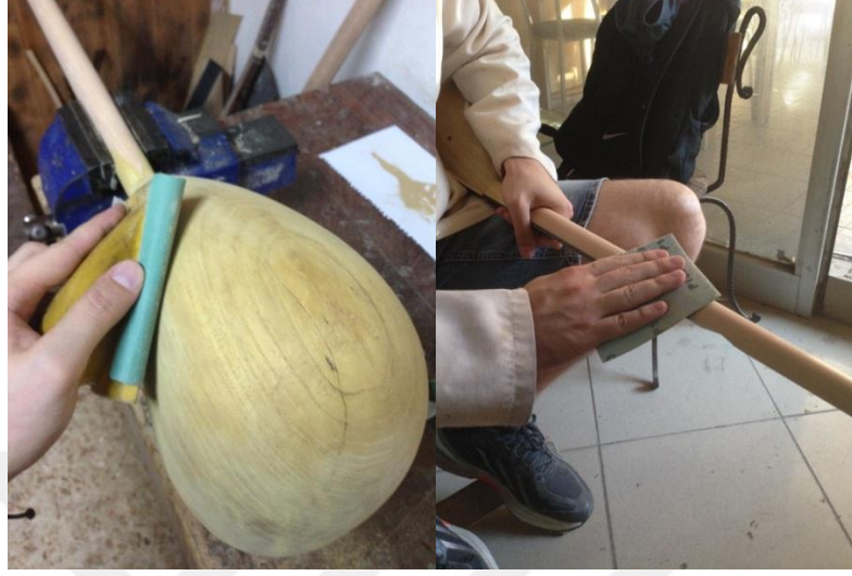
Şekil 3.10. 1 : Enstrümanın Cila Öncesi Temizliği
