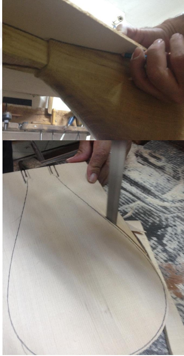
Şekil 3.6. 3 : Ses Kutusu İşaretleme ve Kesme İşlemi
