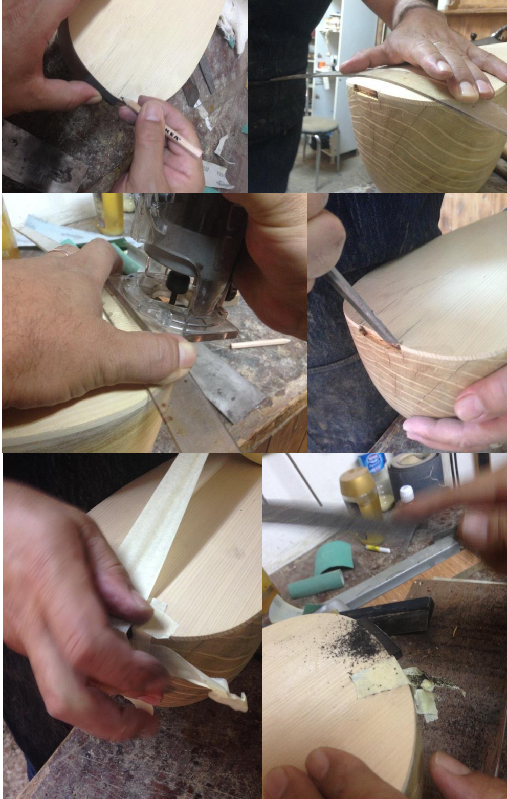
Şekil 3.10. 2 : Alt Eşiğin Montajı
