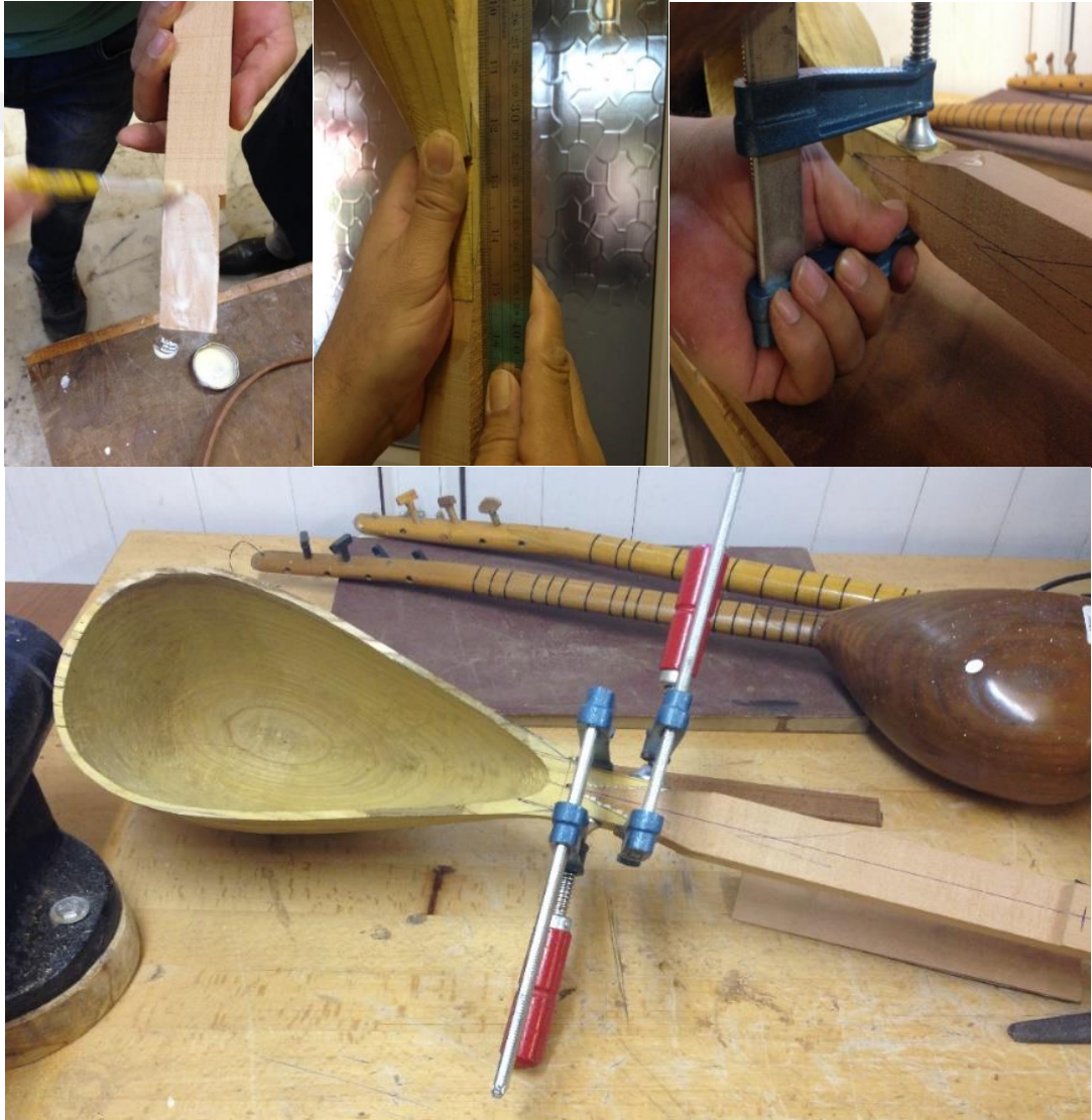
Şekil 3.5. 7 : Sapın Tutkallanması, Doğrusal Düzlem Kontrolü, Sıkıştırma İşlemi ve Kurumaya Bırakılması
