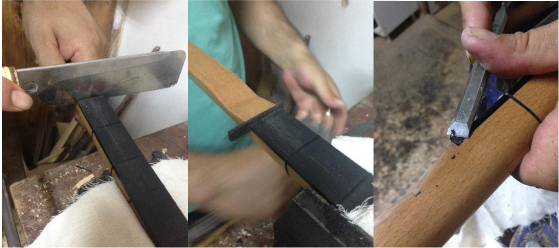
Şekil 3.13. 1 : Üst Eşik Yapım ve Montajı
