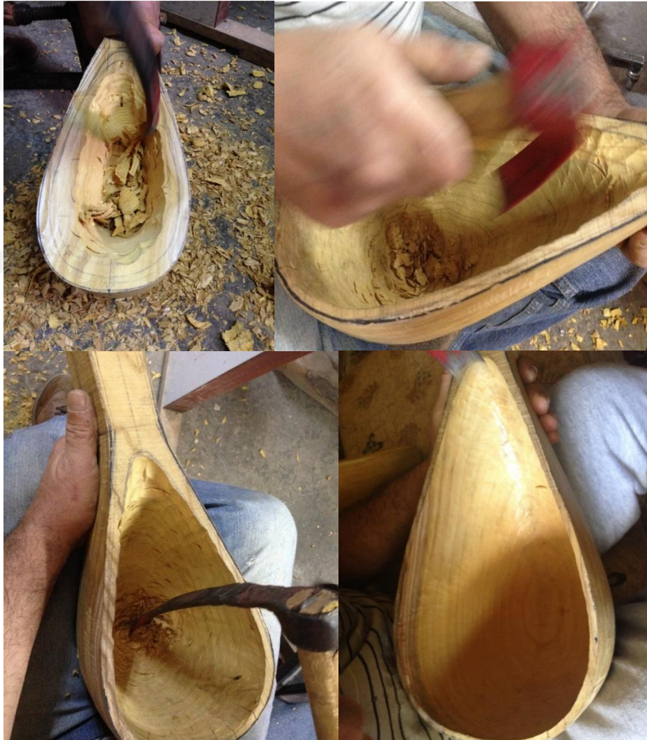
Şekil 3.4. 1 : Farklı Keserler İle Oyma İşlemleri ve Son Hali.
