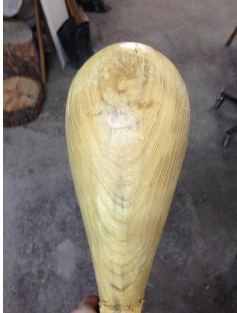
Şekil 3.3. 3 : Ses Kutusu Dış Formunun Bitmiş Hali.
