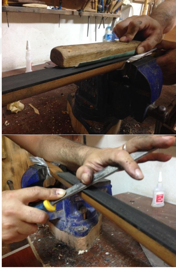
Şekil 3.12. 1 : Tuş Tesviyesi ve Pah Kırma İşlemleri
