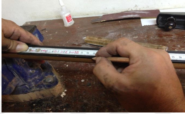
Şekil 3.12. 2 : Perdelerin Yerlerinin İşaretlenmesi
