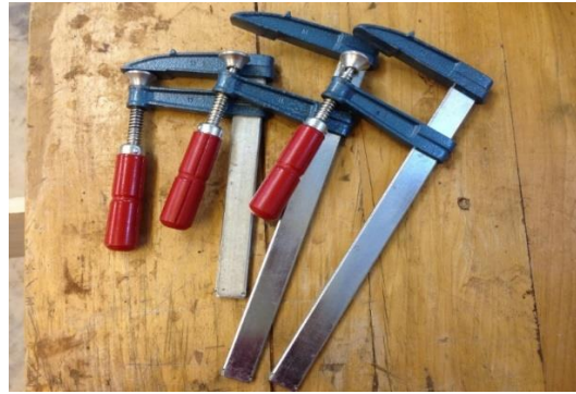
Şekil 2.2.8. 3 : Vidalı Demir İşkence
