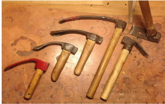
Şekil 2.2.2. 1 : Oyma Keserleri ve Düz Keserler
