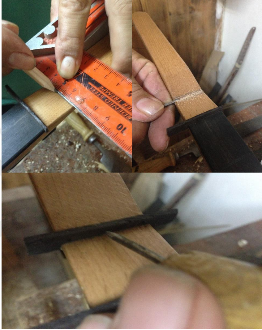
Şekil 3.13. 2 : Boğma Eşik Yapım ve Montajı
