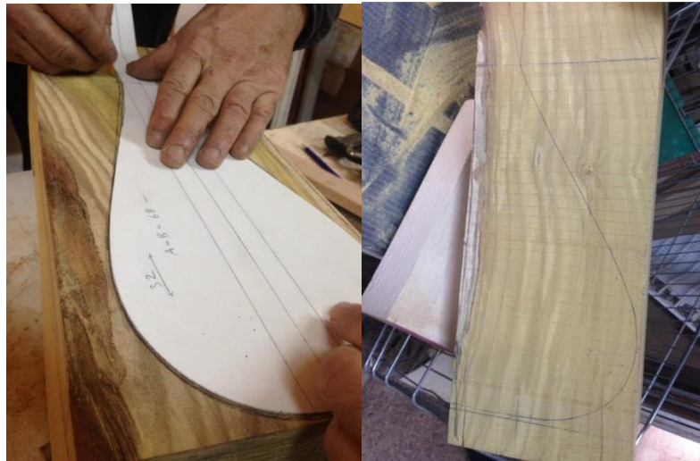
Şekil 3.2. 1 : Boy, Genişlik ve Derinlik Çizgileri.
