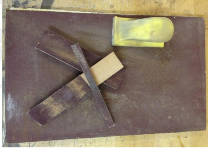
Şekil 2.2.5. 2 : Zımpara Takozları ve Zemin Zımpara
