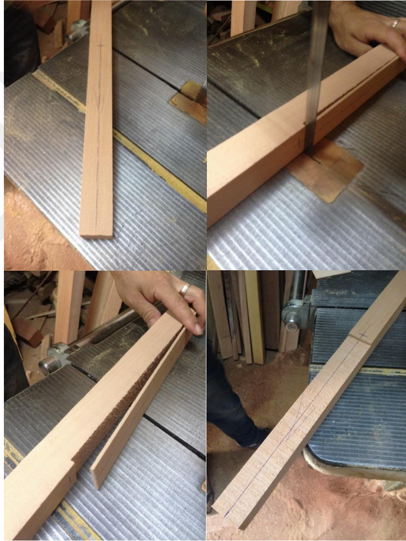
řekil 3.5. 5 : Geçici Klavye Yerinin Hazırlanışı
