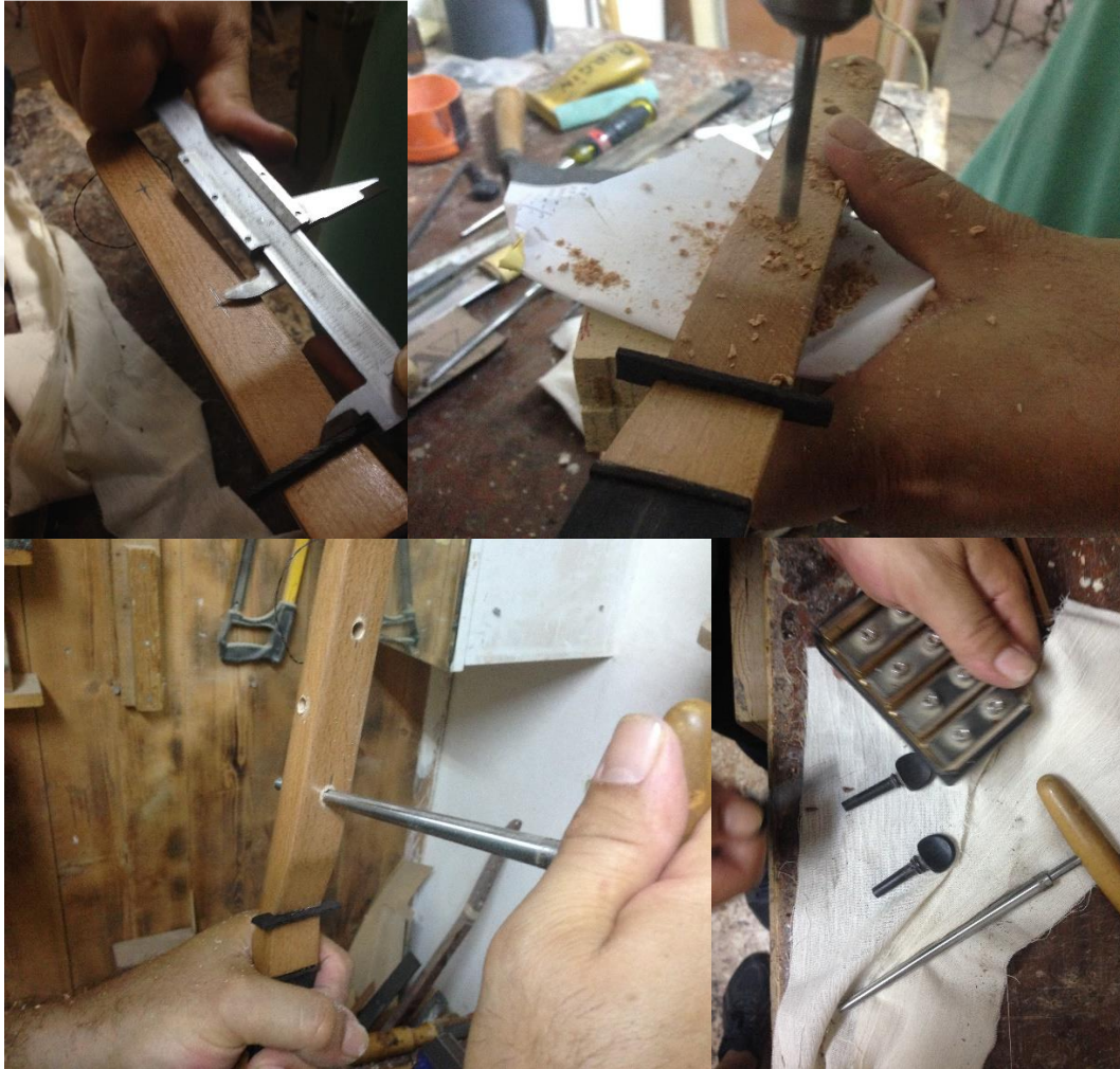
Şekil 3.14. 1 : Burgu Yuvalarının Açılması ve Burgunun Alıştırılması
