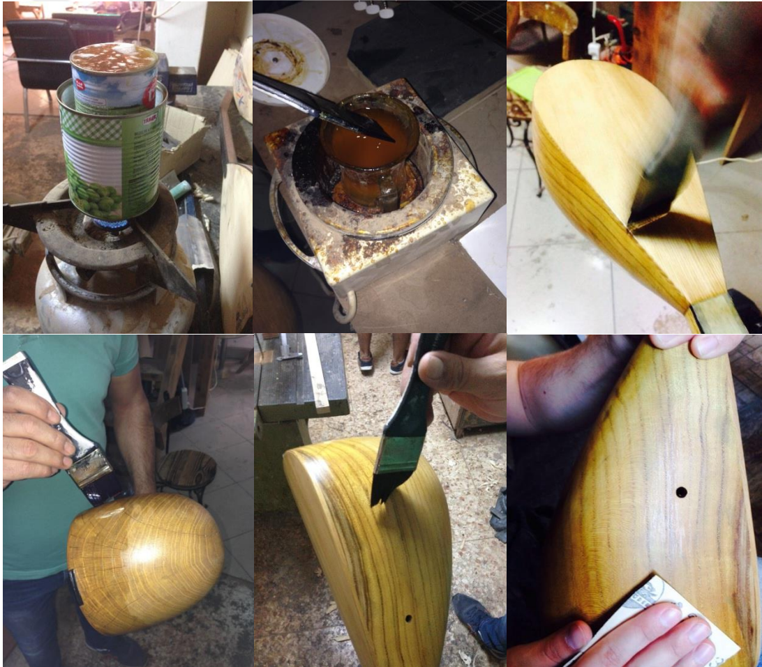
Şekil 3.11. 2 : Cila Isıtma, Sürme ve Temizlik Aşaması
