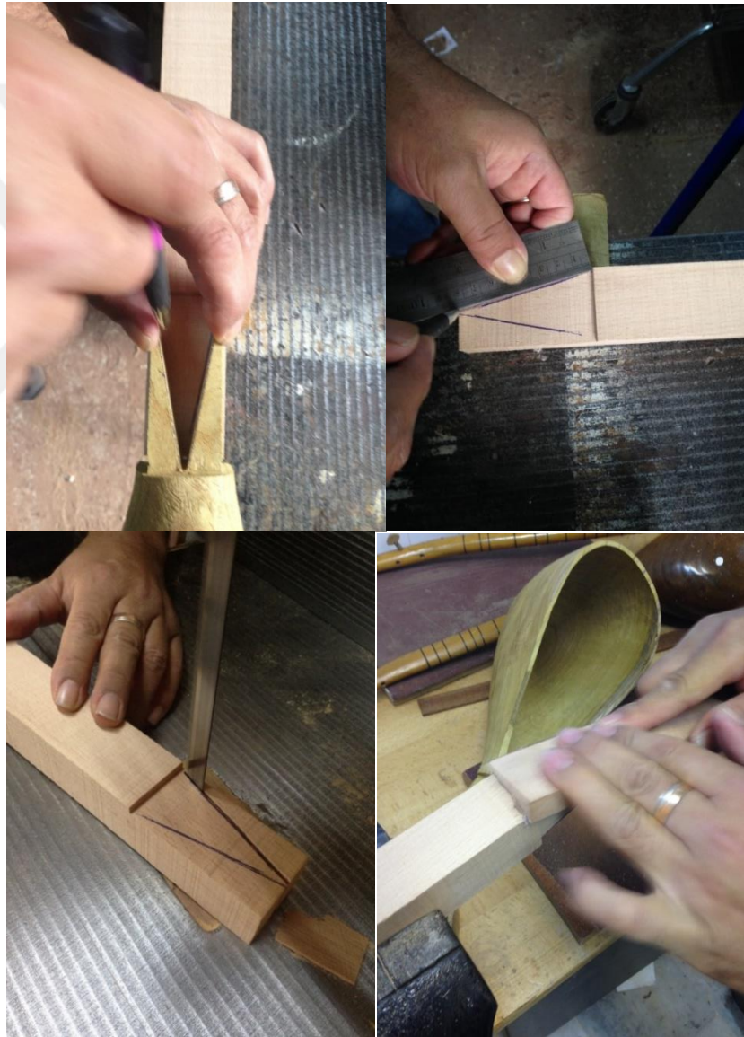
Şekil 3.5. 6 : Sap Kısmı Kurt Ağzı Geçkinin İşaretlenmesi, Kesilmesi ve Tesviyelenmesi.
