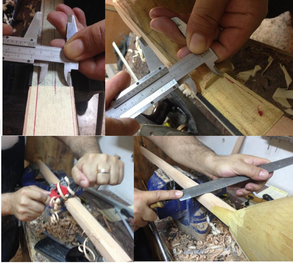
Şekil 3.9. 1 : Sap Formunun Verilmesi İşlemi
