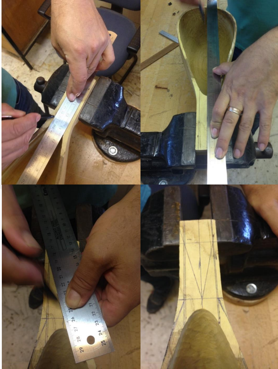
řekil 3.5. 3 : Kurt Ağız Gekinin Ses Kutusuna izilmesi İřlemi
