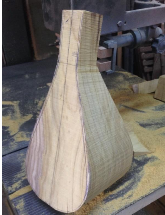
Şekil 3.2. 3 : Şerit Testere Makinası İle Son Hali Verilen Ses Kutusu
