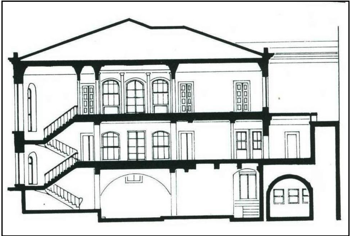
Şekil 5.93: Konağın Merdiveninden Geçen Restorasyon Kesiti
