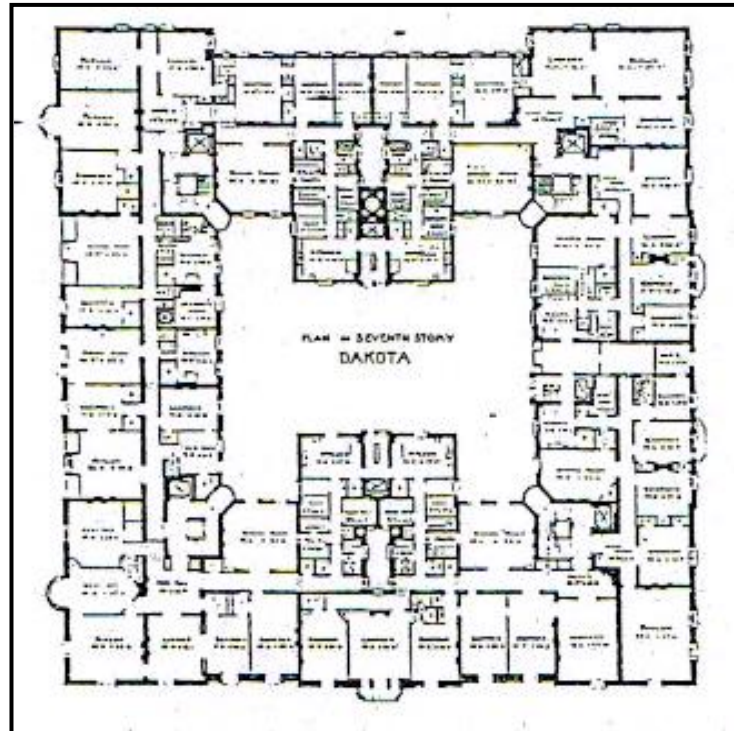
Şekil 4.4: Amerika’daki apartman türü konutların en belinenlerinden DAKOTA. (Daha çok avlulu plan özellikleri gösteren Amerika’daki apartmanlar, varlıklı kesimin konutu olarak yapılmışlardır. Bir katta çok sayıda dairenin bulunduğu yapılar, cephe olarak eklektik özellik göstermektedir.)
