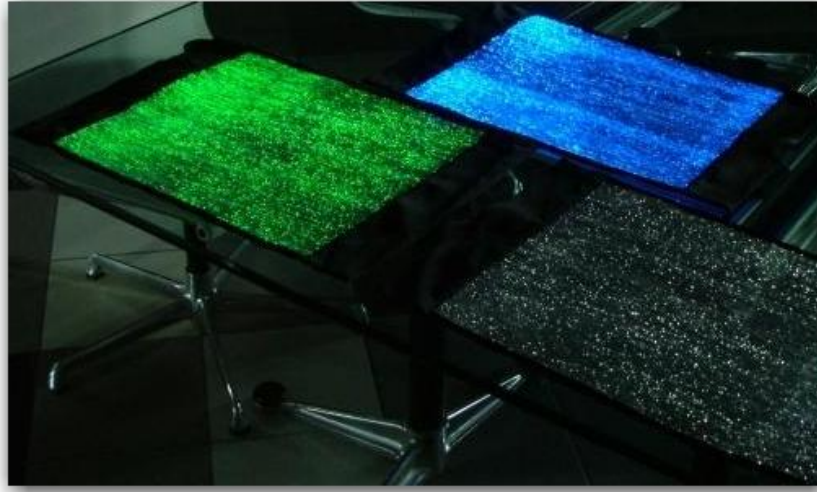
Resim 3.5. Fiber optik kumaş (Luminex®), renkli ışığı tüm yüzeye yayabiliyor ve böylece çok hoş bir aydınlık ortaya çıkararak, karanlıkta şaşırtıcı bir atmosfer yaratıyor. 188
