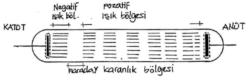
Şekil 2.9. Geisler Tüpünün Çalışma Prensibi ve Bölümleri 159
