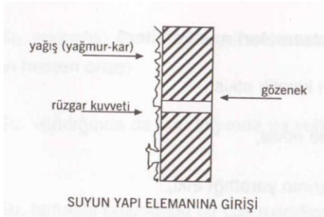
“Şekil 2.1” Suyun yapı elemanlarına girişi
