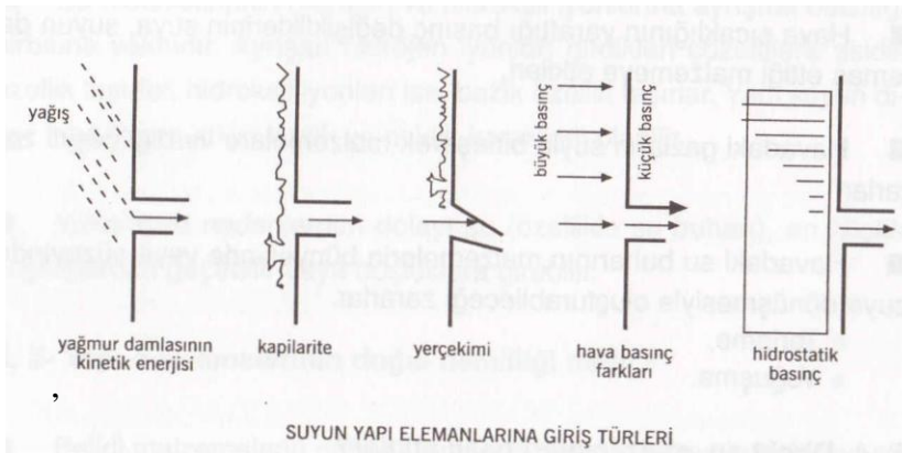
“Şekil 2.2” Suyun yapı elemanlarına giriş türleri
