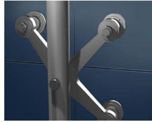
Resim 4.9. Transparan Cephe Sisteminde Kullanıldıkları Yere Göre Üç Yönlü Bağlantı Elemanı
