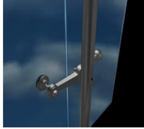
Resim 4.8. Transparan Cephe Sisteminde Kullanıldıkları Yere Göre İki Yönlü Bağlantı Elemanı
