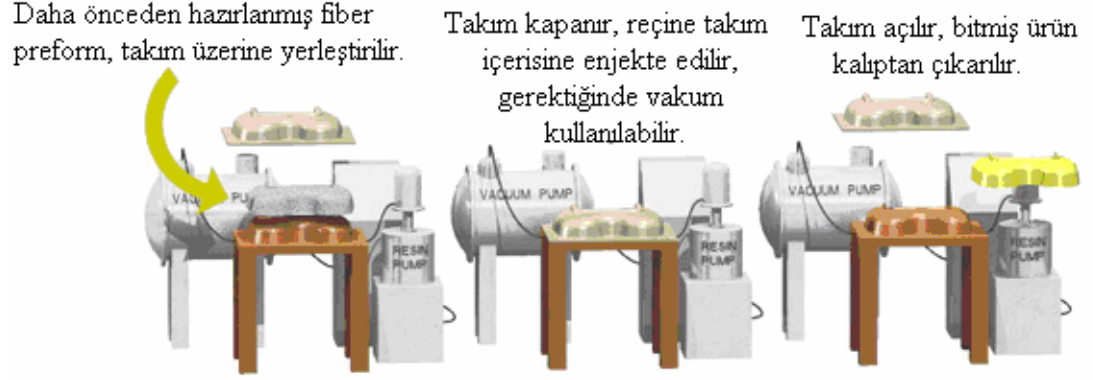
Şekil 1.9. Reçine Enjeksiyonu Sistemik Yöntemi
