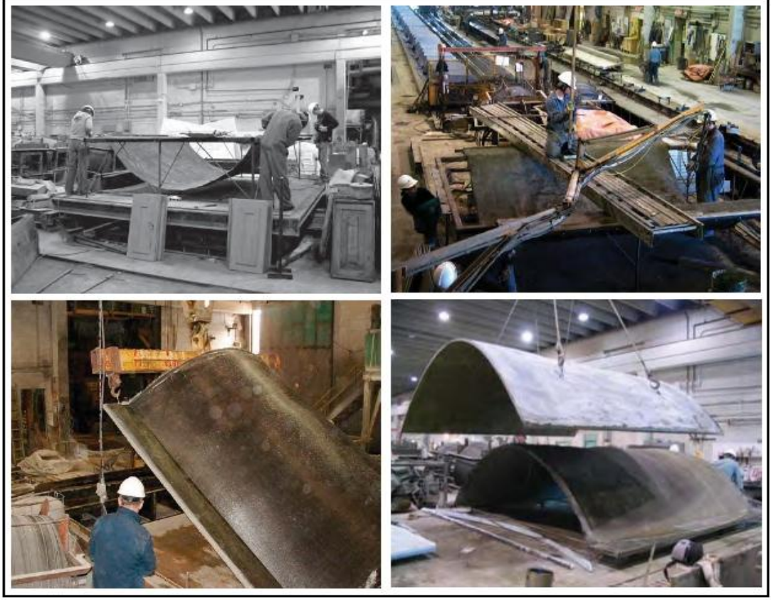
Resim 1.6. Hazır kalıplama yöntemi ile yapılan kompozit esaslı prekast kabuk kalıp yapımı 23
