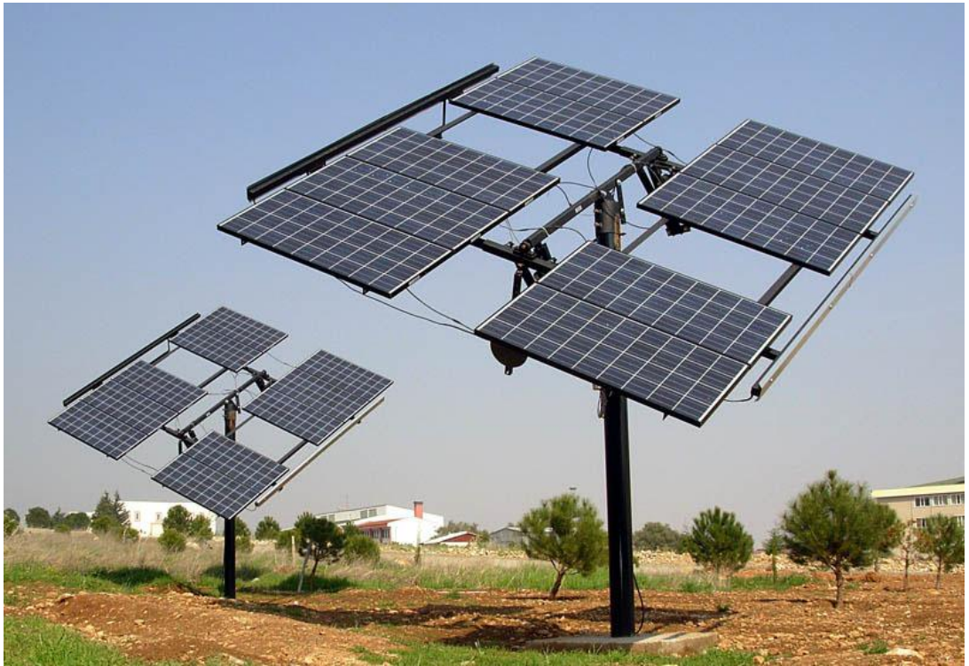
Resim 7.27:Kullanılan İki Adet Tek Eksenli Pasif Güneş İzleyicisi
