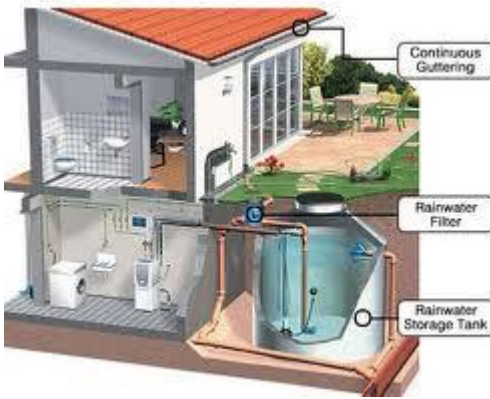
Şekil 3.5: Yağmur suyu toplama kanalları
