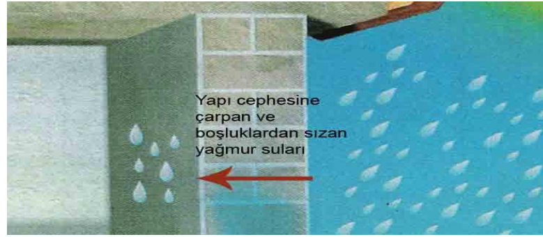
Resim 2.4. Yağışlar ve Yapı Cephesine Etkisi
