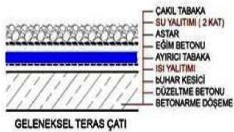
Şekil 4.28. Geleneksel Teras Çatı Yalıtım Katmanları
