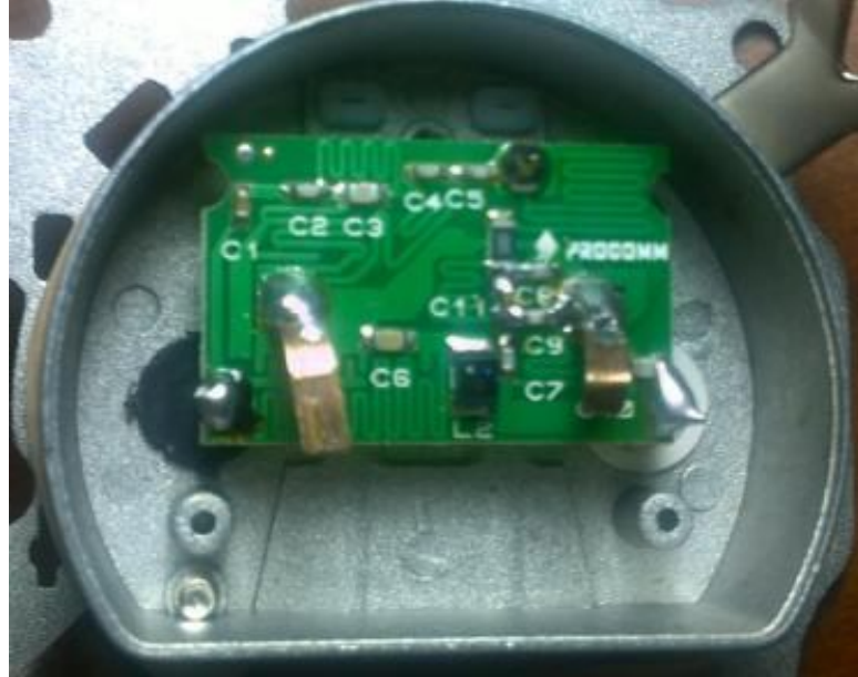
Şekil 4.85. Üretimi yapılmış ve kılıfa yerleştirilmiş işaret birleştirici
