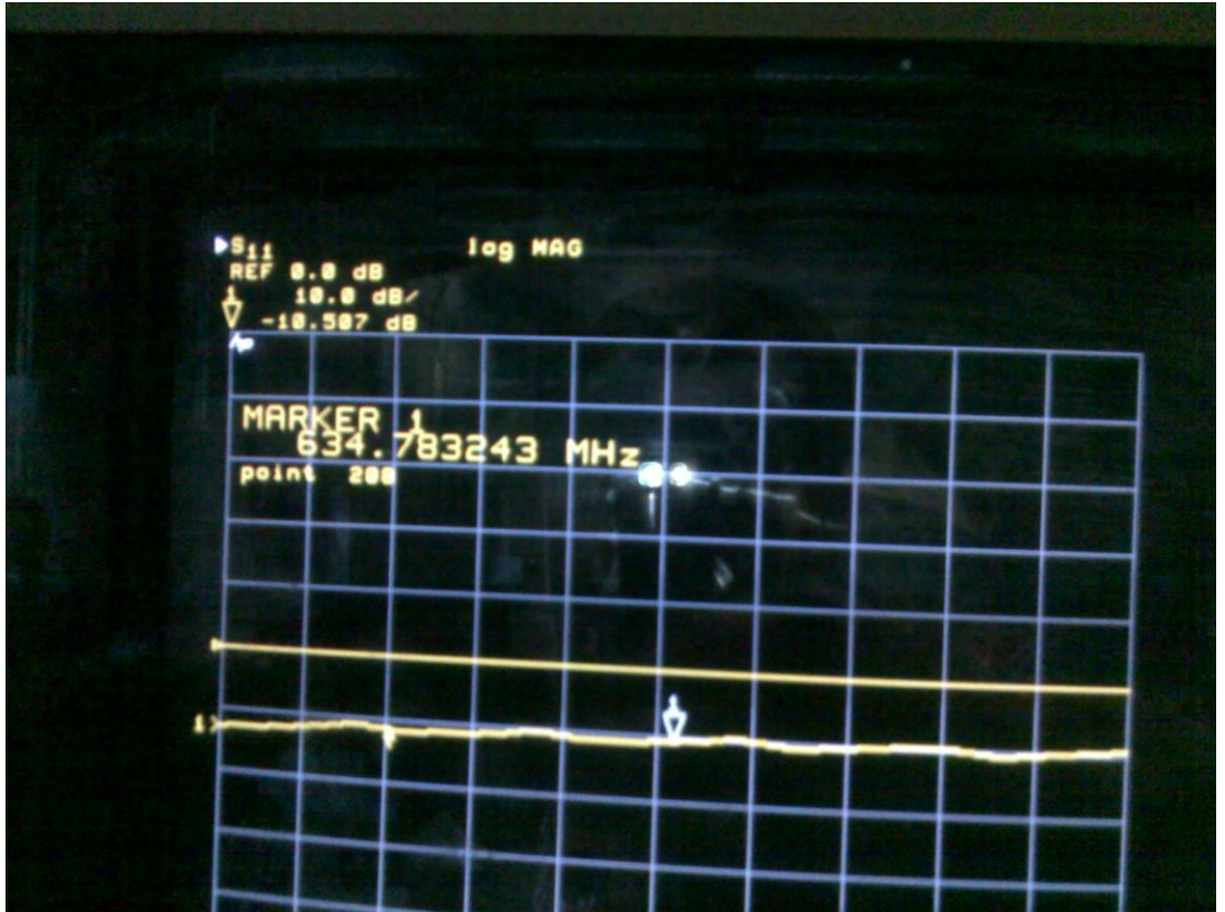
Şekil 7.122 UHF kuvvetlendiricisinin 634 MHz frekansında S_{11} -10.587 dB.
