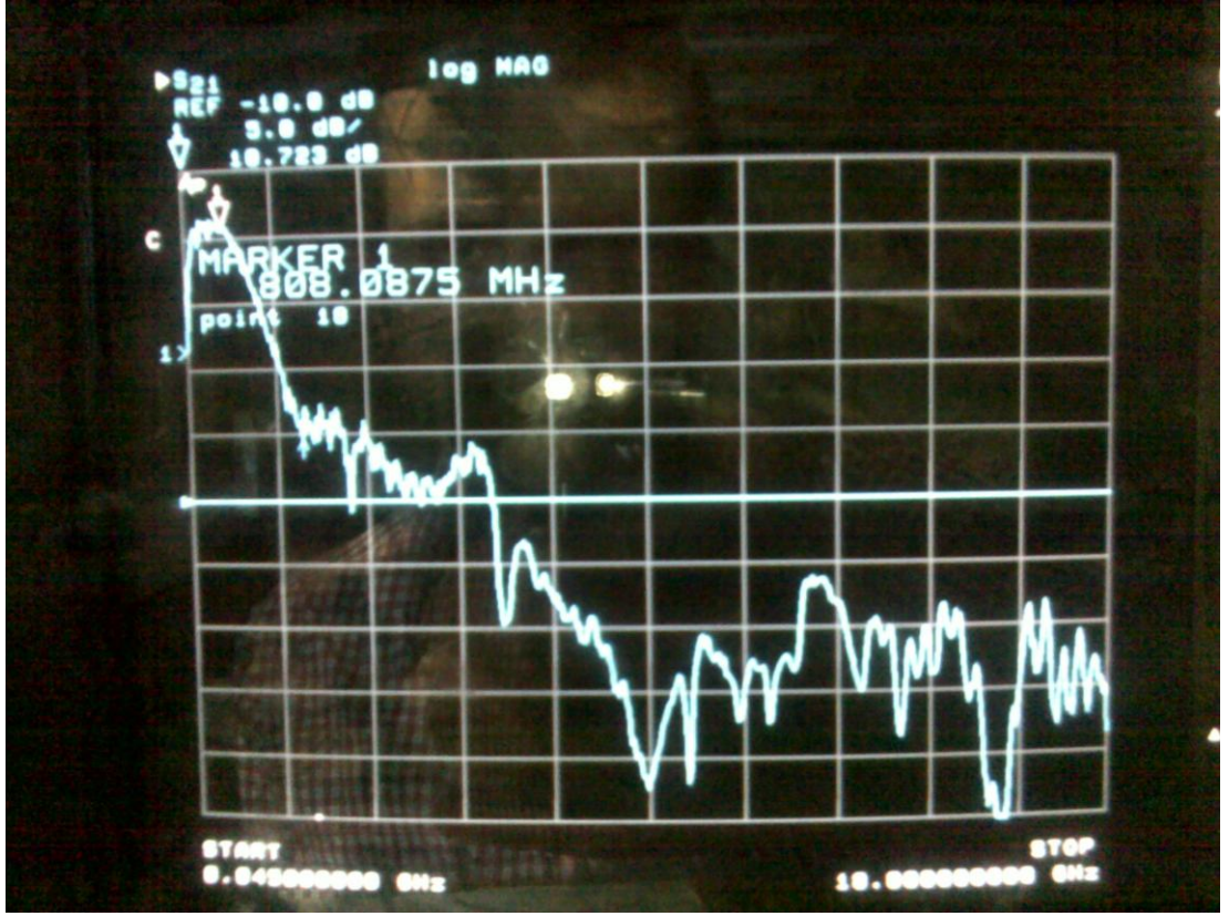
Şekil 7.117 UHF kuvvetlendiricisinin 808 MHz frekansında 10.723 dB kazanç.
