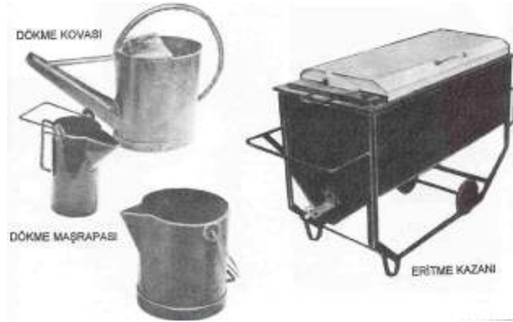
Resim 4.16 Sıcak bitüm karışımının oluşturulmasında ve dökülmesinde kullanılan araçlar 120
