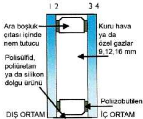
Şekil 4.6 Standart yalıtım camı ünitesi kesiti 157
