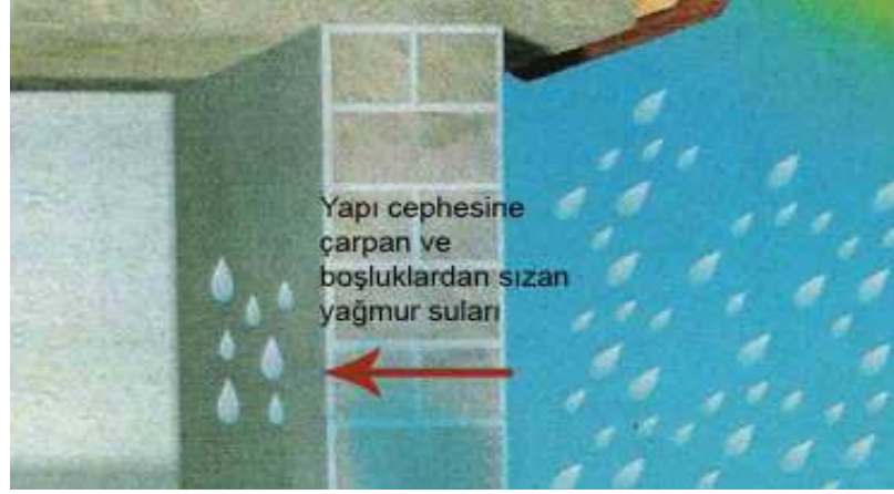
Resim.2.5 Yağışlar ve yapı cephesine etkisi 17
