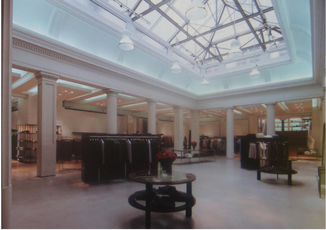
Şekil 3.62 Kwesto mağazası. Mimarının izin verdiği ölçüde gün ışığından yararlanılmıştır. Satış alanının geri kalan bölümleri ise, alçıpan içine yerleştirilen aydınlatma elemanları ile oluşturulan ışık havuzları tarafından aydınlatılmaktadır (New Shops, 2000: 20).
