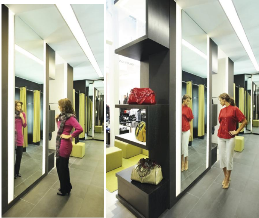
Şekil 3.58 Deneme Odalarında Aydınlatma. Deneme odalarında uygulanacak olan aydınlatma, gün ışığı rengine yakın olmalıdır. Bu şekilde müşteriler denemekte oldukları kıyafetin gerçek rengini görebileceklerdir. Ayrıca, kullanılan armatürün açısı, müşteriyi güzel gösterecek, müşteri üzerinde gölge yapmayacak şekilde ayarlanmalıdır (Philips, 2011: 14).
