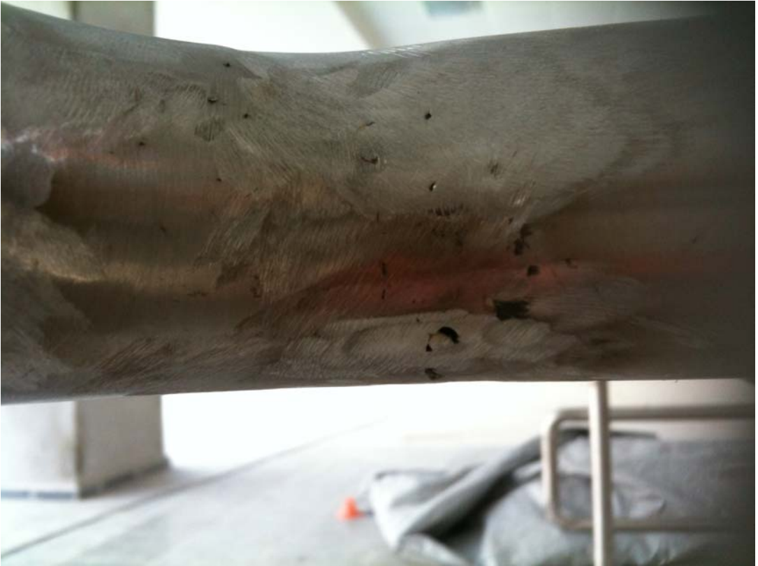
Şekil 5.15: Hatalı kaynak tipi seçimi, zımparalama ve temizlik uygulaması (Gökhan Mermi Arşivi)
