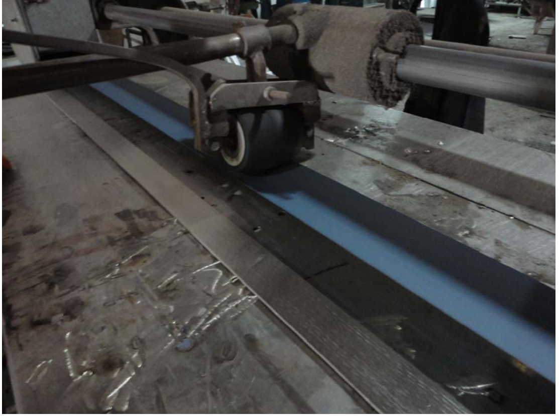
Şekil 5.11: Zımparalama ile Satineleme ve temizlik uygulaması (Gökhan Mermi Arşivi)
