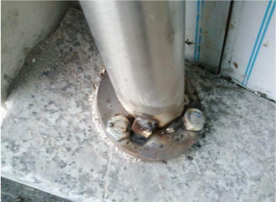
Şekil 5.7: Hatalı kaynak uygulaması (Gökhan Mermi Arşivi)
