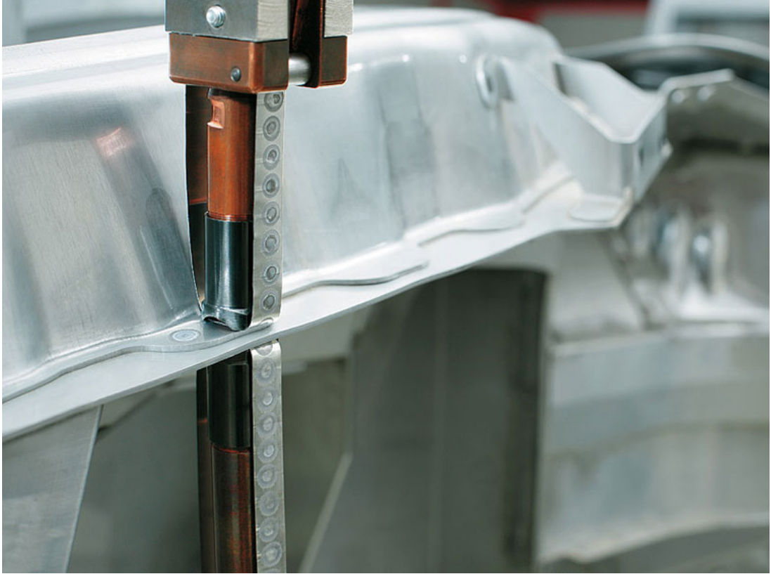
Şekil 4.17: Paslanmaz çelik malzemeye direnç kaynağı uygulaması ( www.fronius.com )
