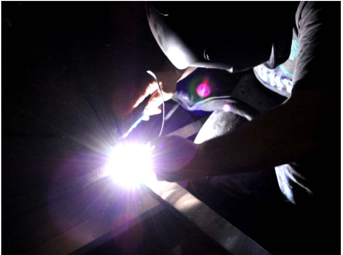
Şekil 4.12: Paslanmaz çelik malzemeye argon kaynağı uygulaması (Gökhan Mermi Arşivi)
