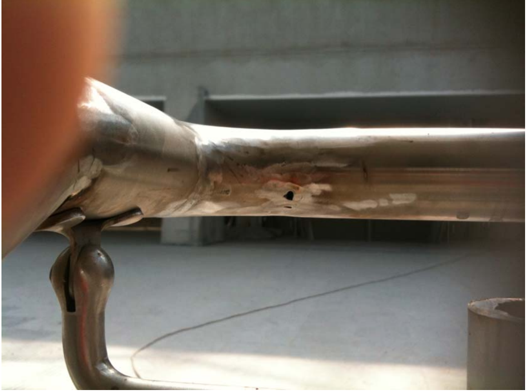
Şekil 5.14: Hatalı kaynak tipi seçimi, zımparalama ve temizlik uygulaması (Gökhan Mermi Arşivi)
