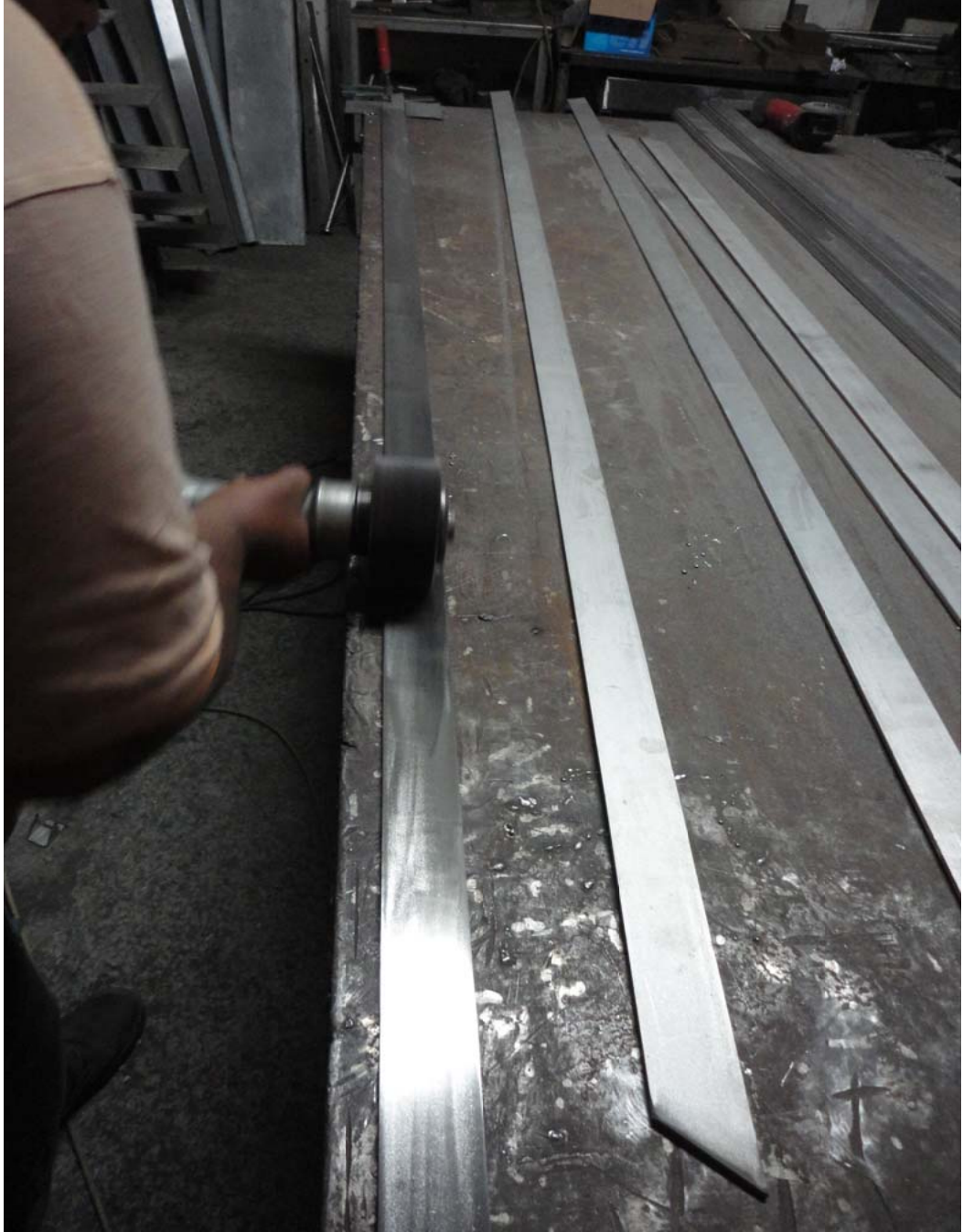
Şekil 5.10: PTX ile Satineleme ve temizlik uygulaması (Gökhan Mermi Arşivi)
