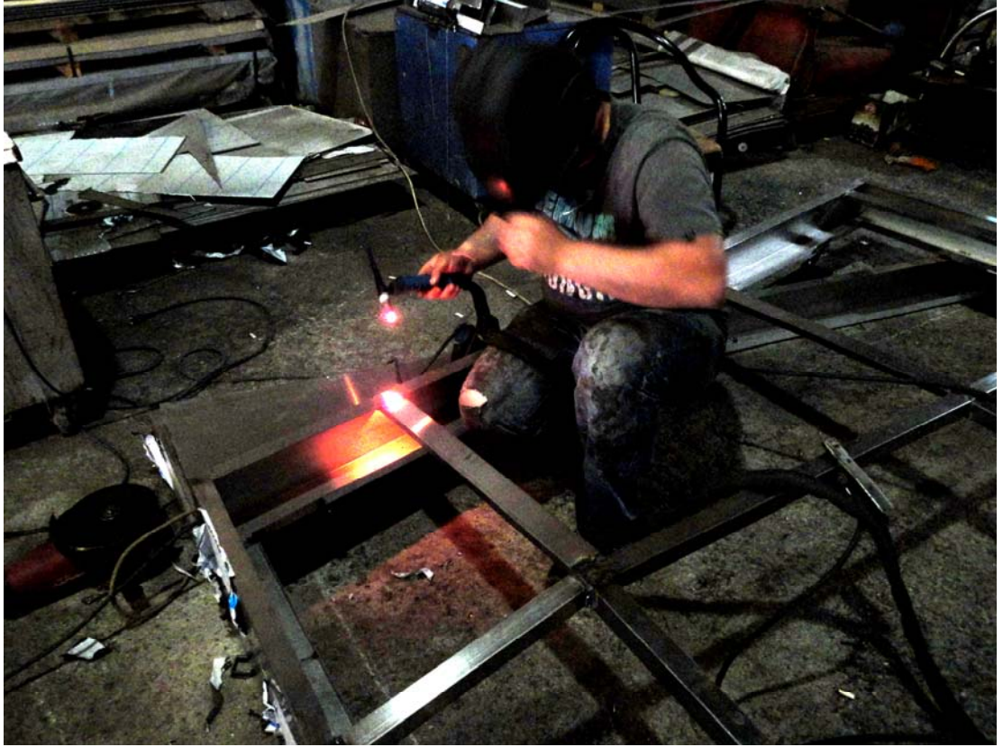
Şekil 4.11: Paslanmaz çelik malzemeye argon kaynağı uygulaması (Gökhan Mermi Arşivi)
