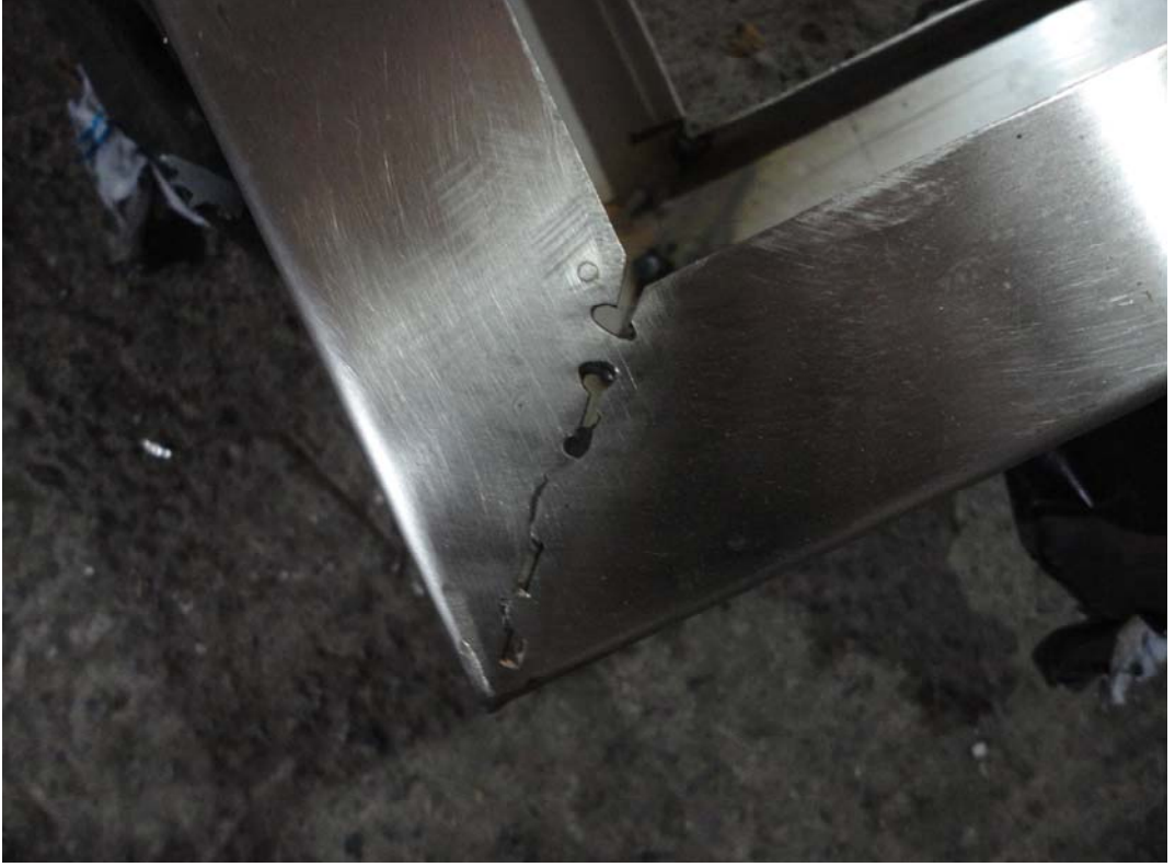
Şekil 5.12: Hatalı kaynak tipi seçimi, zımparalama ve temizlik uygulaması (Gökhan Mermi Arşivi)
