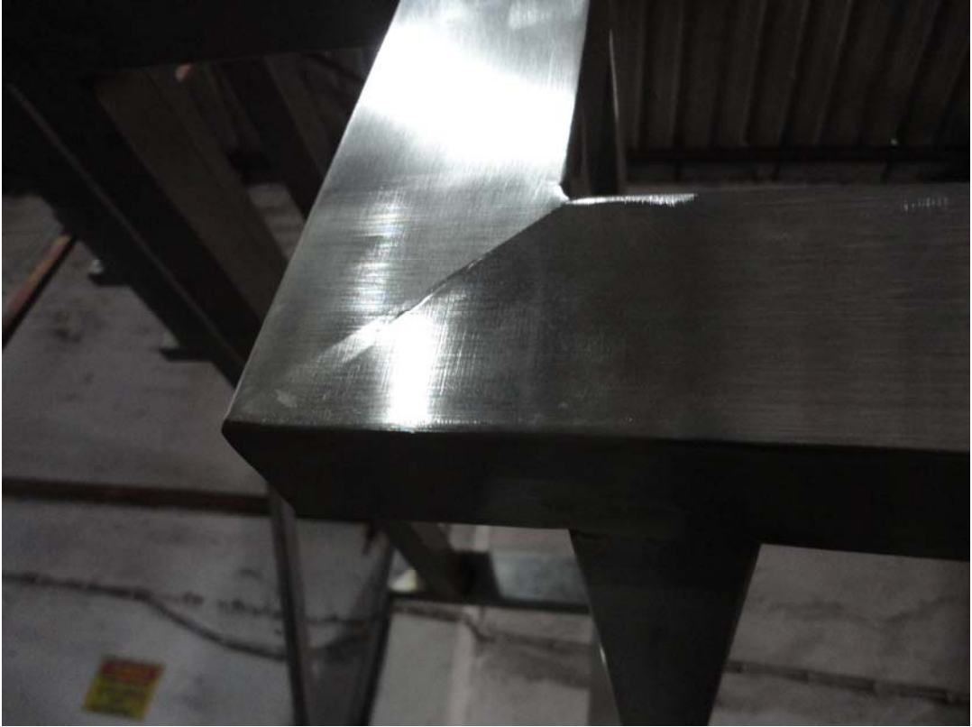
Şekil 5.13: Doğru kaynak tipi seçimi, zımparalama ve temizlik uygulaması (Gökhan Mermi Arşivi)
