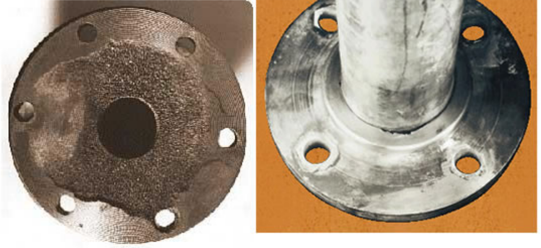
Şekil 4.8: Paslanmaz çelik malzeme için aralık korozyonu örneği
