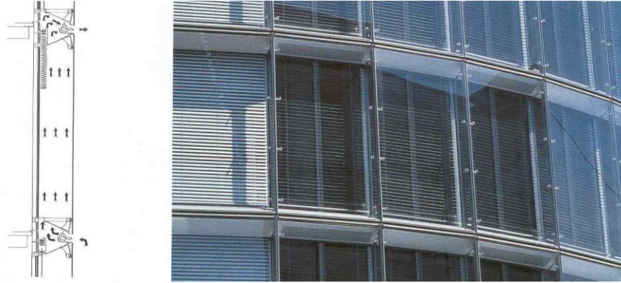
Şekil 3.24 Kat Yüksekliğinde Çift Kabuklu Cephe sistemi detayı
