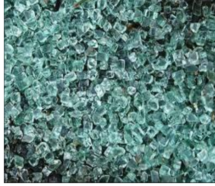
Şekil 3.41. Temperli camın kırılma esnasında gösterdiği davranış
