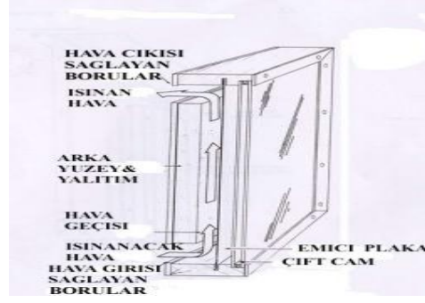
Şekil 3.28 Kesit, Havalı Düzlemsel Kolektör
