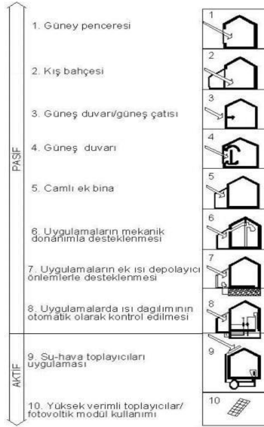
Şekil 3.1 Pasif ve Aktif Sistemle Güneş Enerjisinden Yararlanma Prensipleri
