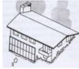
Şekil 3.34 Yapıdan Alt Kotta Yerleştirilen Güneş Kolektörleri
