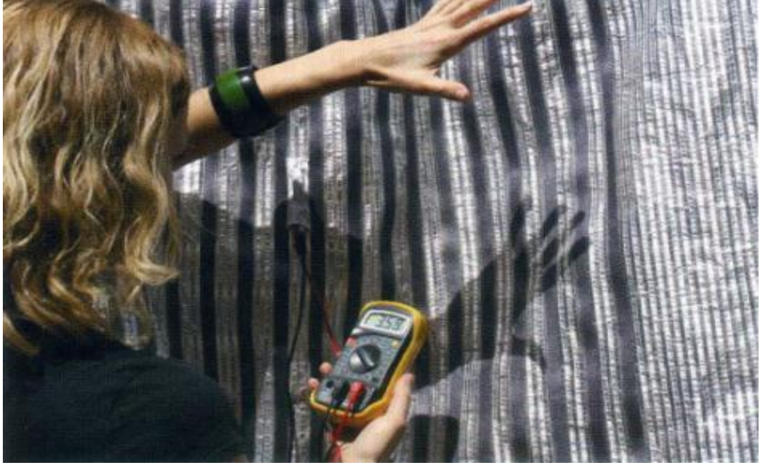
Resim 2.15-Mimar Sheila Kennedy ve Ekibinin Tasarladığı İnce Şeritli Fotovoltaik Kumaş
