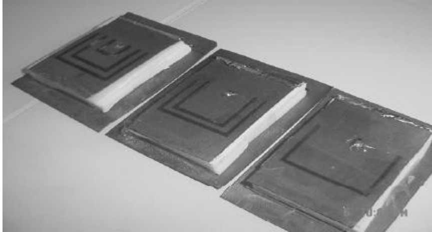
Şekil 2.20 - U şeklinde delikler açılmış antenin üstten görünümü
