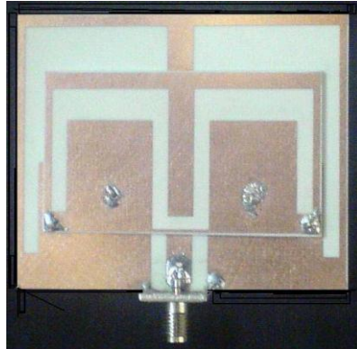
Şekil 2.22 – L şeklinde tasarlanan antenin geometrik görünümü
