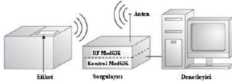
Şekil 3.11. RFID sisteminde kullanılan bir denetleyici
