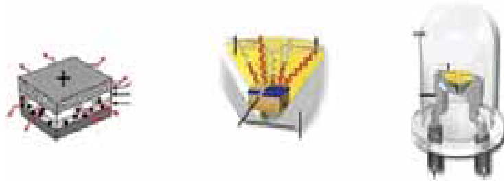
Resim 2.7. LED'in İç Yapısı 11
