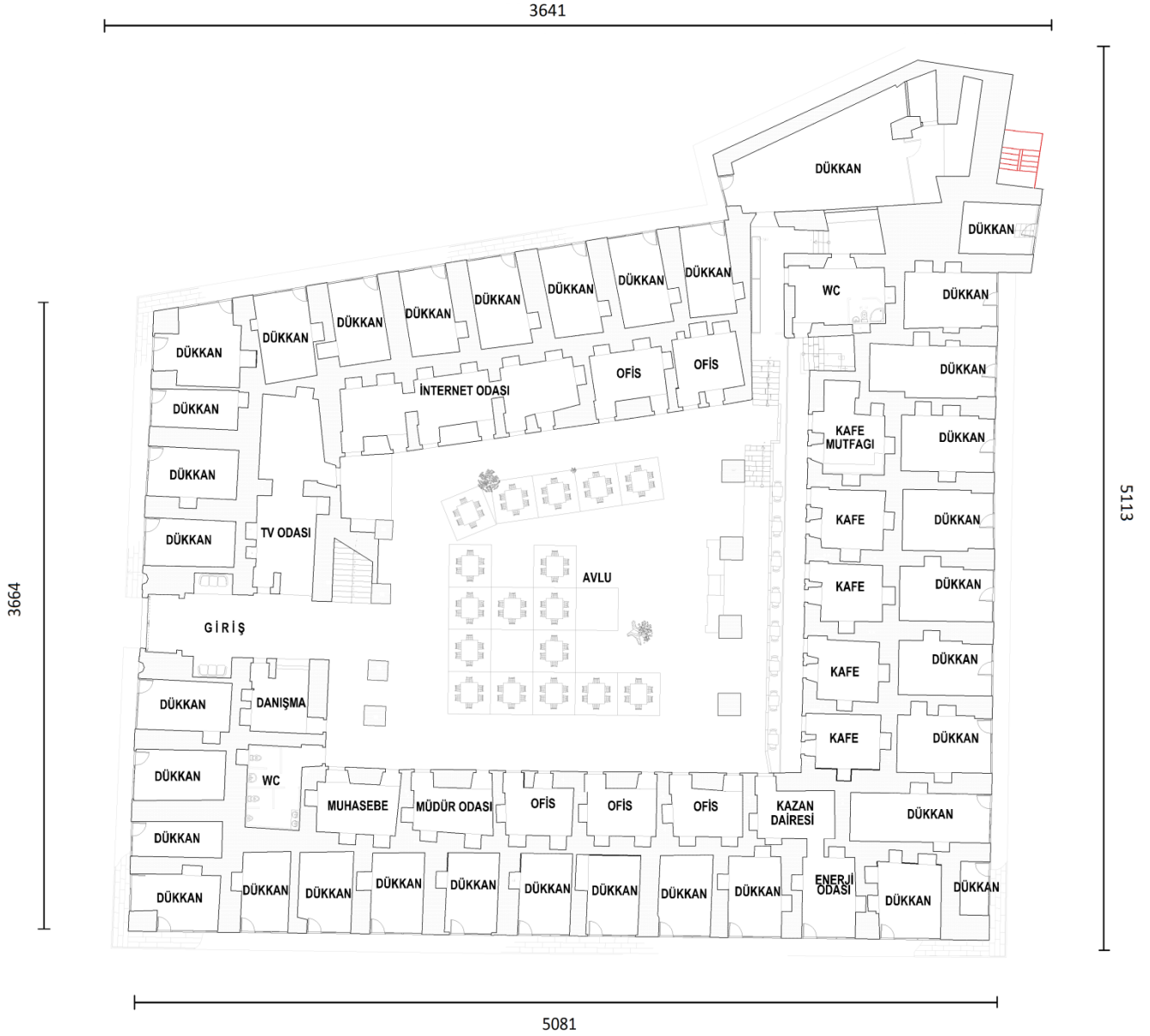
Şekil14 ( 0.00 kotu) Restorasyon Zemin Kat Planı
