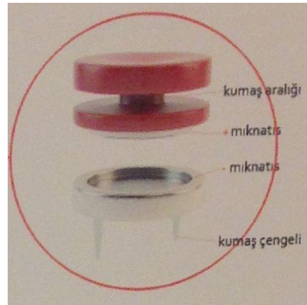
Şekil B3: Artieksi düğme yapısı
