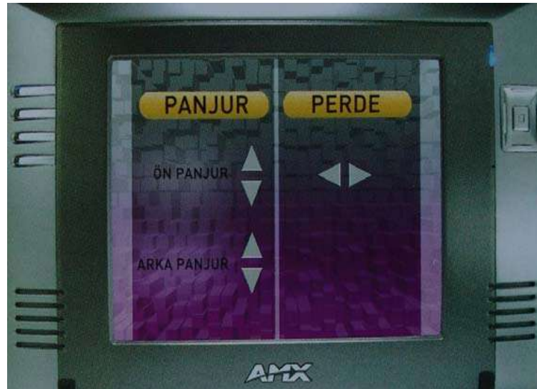
Resim 3.17. Panjur- perde kontrolü seçilmiş touch panel
