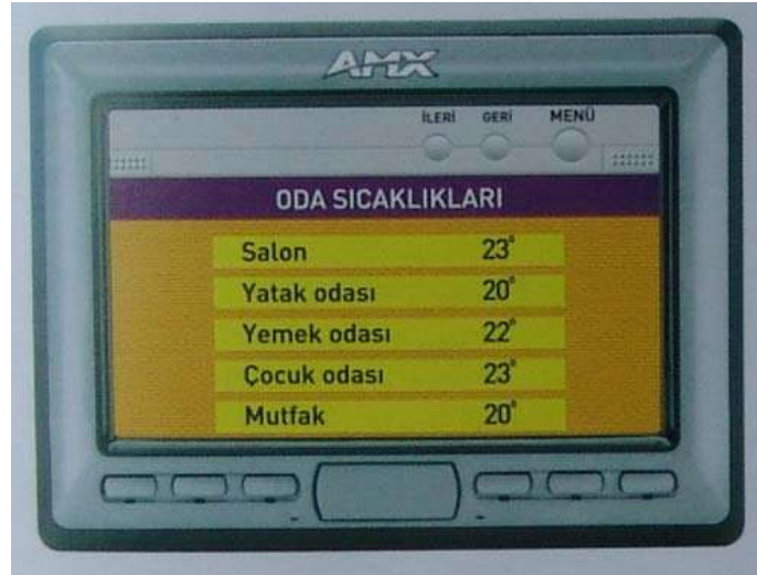
Resim 3.10. Oda sıcaklıklarının touch panelden izlenmesi.
