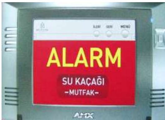
Resim 3.24. Su kaçağını ve mekanı gösteren touch panel.
