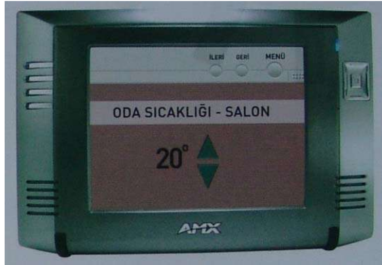
Resim 3.12. Oda sıcaklık derecesi seçilmiş touch panel.
