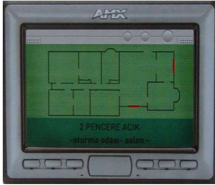
Resim 3.23. Plan üzerinden açık pencereleri gösteren touch panel
