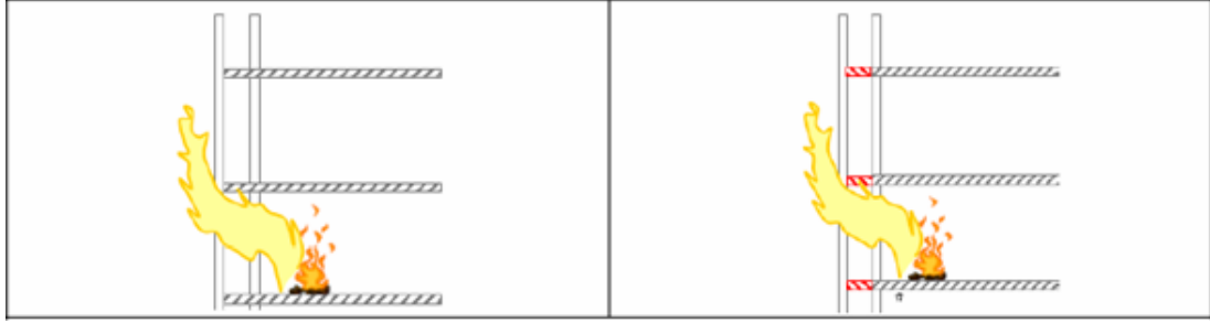
Şekil 5.28 – Yangın sırasında cephe sisteminin çalışma prensibi
