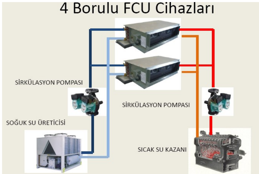
Şekil 7.7 – 4 Borulu Fan-Coil Sistemi
