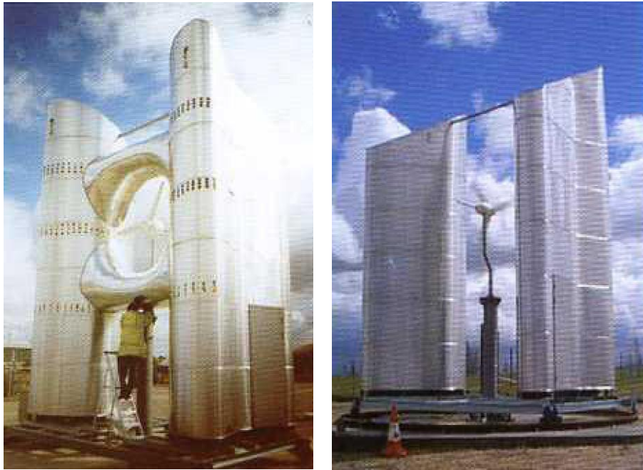
Şekil 5.44. Rüzgar türbinlerin 7 m yüksekliğinde prototipler üzerinde test edilmesi [81]
