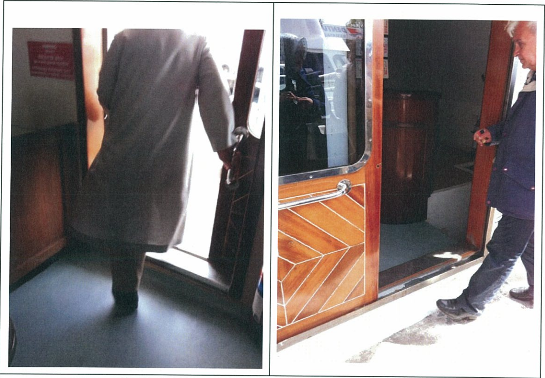
Şekil 4.13 Mevcut Teknelerde Bulunan Eşikler (E.KUM;2014)
