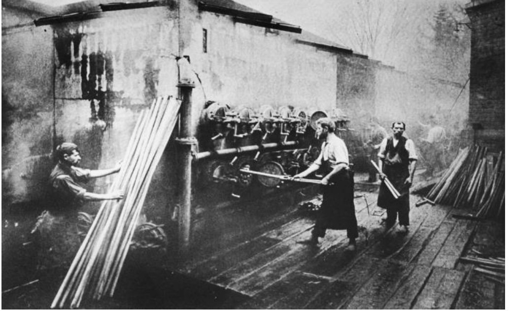
Şekil 4.4. Thonet Fabrikası Üretim Süreci
